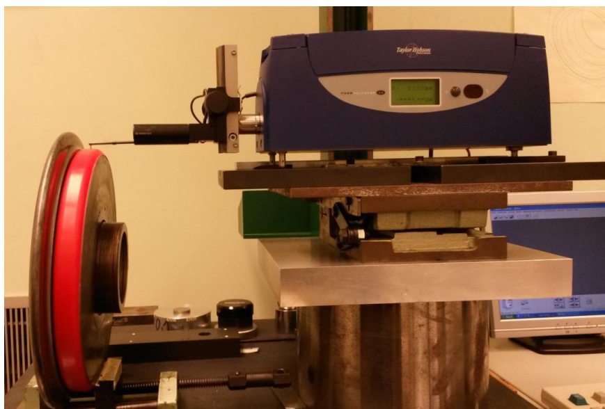
Abbildung 51: Versuchsaufbau Messung Oberflächenrauheit Lauffläche
