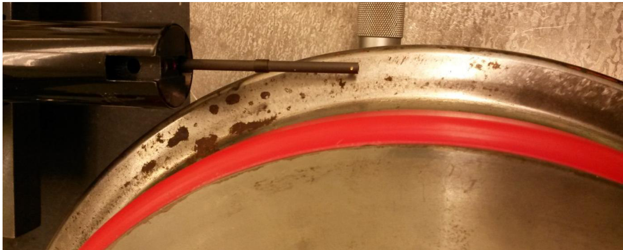
Abbildung 52: Messung Oberflächenrauigkeit Spurkranz
