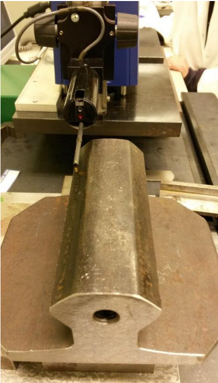
Abbildung 48: Messaufbau Oberflächenmessung Schiene
