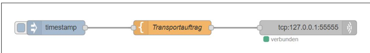
Abbildung 4.12: Erstelltes Flow zur Übertragung von Transportaufträgen über TCP/IP
