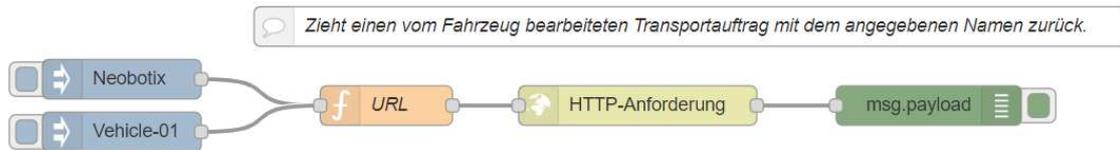
Abbildung 4.25: Flow zum Widerrufen des Transportauftrages eines Fahrzeuges
