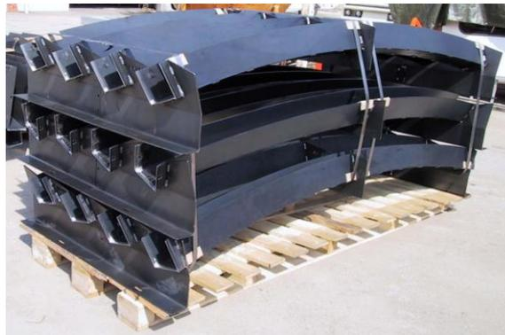
Abb. 1.8: Umlenksattel: Aufgrund hoher Anforderungen an die Geometrie erfolgt die Herstellung zunehmend über automatisch gesteuerte CNC-Fräsen [11]
