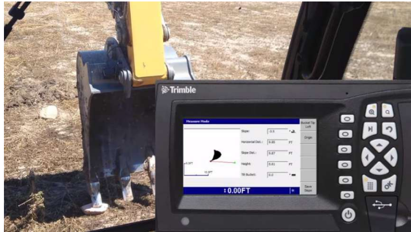
Abbildung 2-28: Ein mit Trimble-Maschinensteuerungssystem GCSFlex ausgerüsteter Hydraulikbagger während der Bestandsaufnahme [82]
