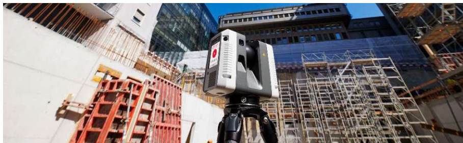
Abbildung 2-25: Laserscanner Leica RTC360 im Einsatz [41]
