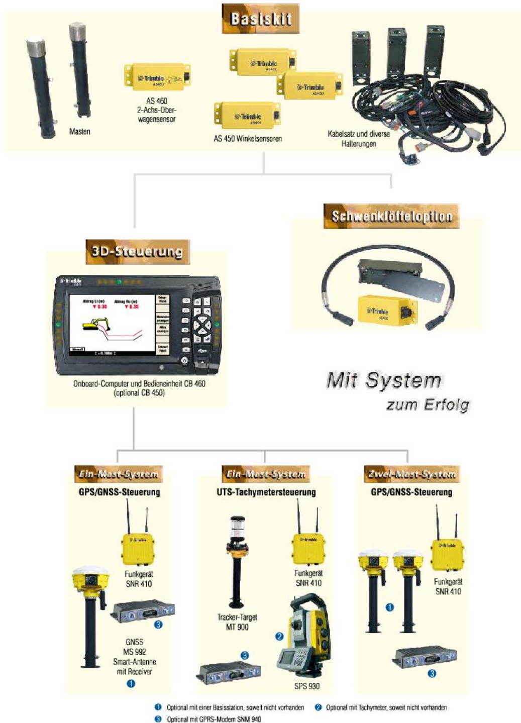
Abbildung 4-2: Systemaufbau GCS900 für den Bagger [59]
