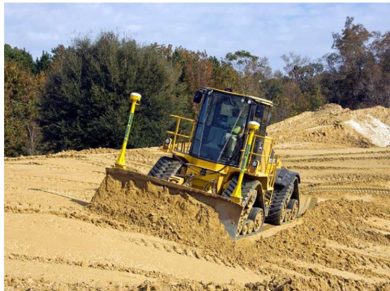
Abbildung 4-4: Planierraupe ausgerüstet mit Trimble GCS900 Dual GNSS [81]
