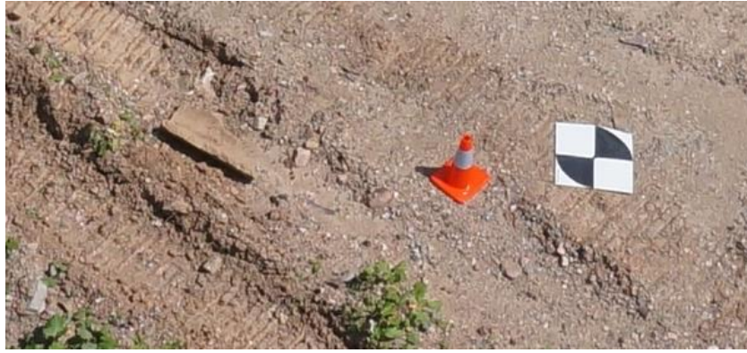
Abbildung 3-4: Passpunkt auf der zu vermessenden Geländeoberfläche [74]
