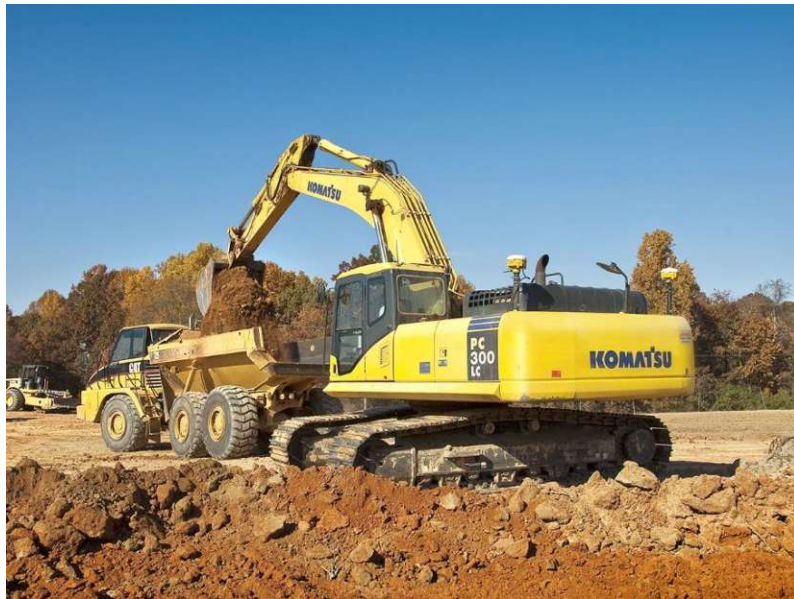
Abbildung 4-10: Hydraulikbagger ausgerüstet mit Trimble GCS900 Dual GNSS [59]
