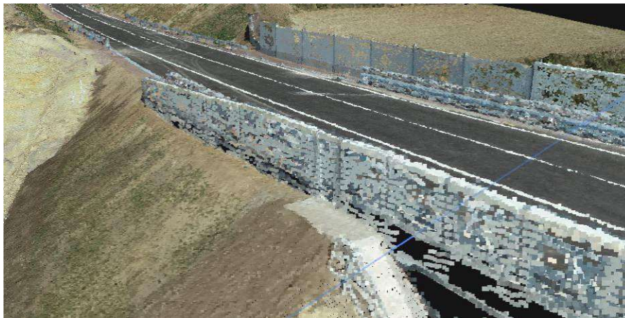
Abbildung 3-5: Beispiel der ausgewerteten Daten in Pix4D [30]
