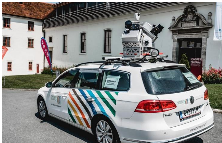
Abbildung 2-29: Beispiel eines Mobile Mapping Systems „Pegasus: Two Ultimate Dualhead“ von Leica Geosystems, verwendet von Joanneum Research [77]
