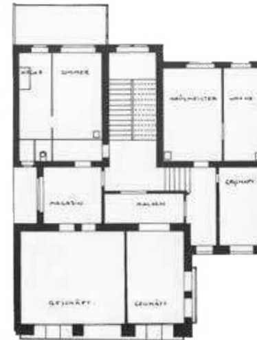
Abb. 10: Wohnhaus St.Pölten, Grundriss Erdgeschoss, 1899
