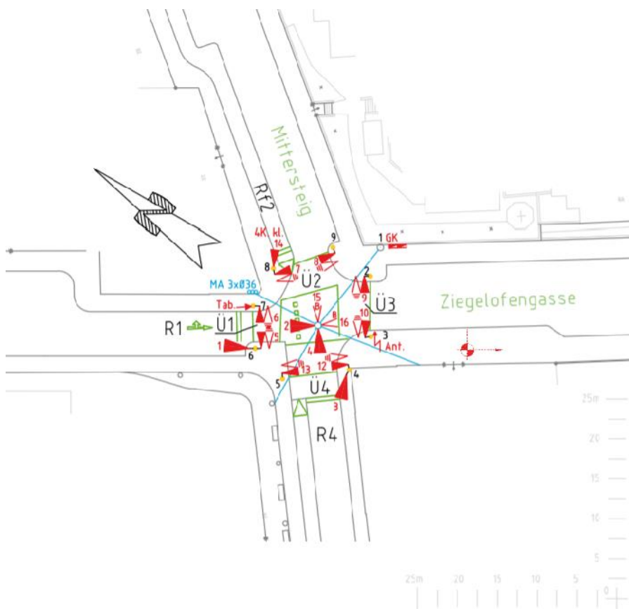
Abbildung 38 Signallageplan V05019, Quelle: Stadt Wien MA33 – V05019_BA_20131203
