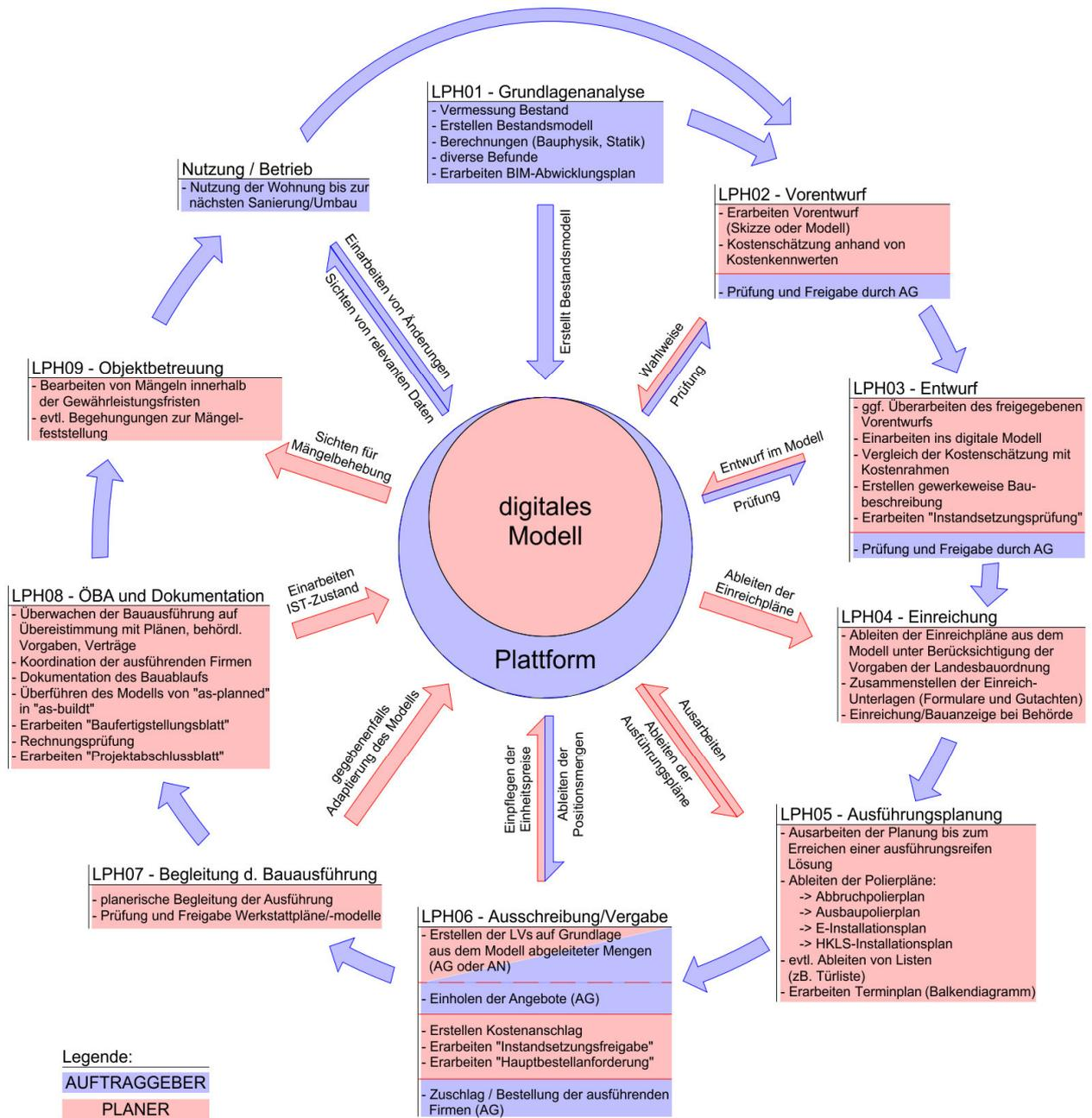
Abb. 34, grafische Darstellung des BIM-basierten Workflows<sup>189</sup>
