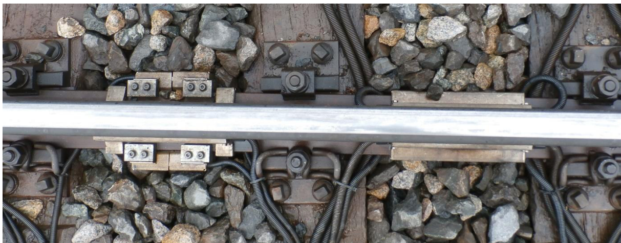
Abbildung 11: Detailansicht Messsensoren - links geschraubte Variante, rechts fest montierte Variante [2]
