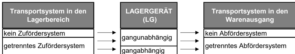
Abbildung 37: Auswahlmatrix zur Gestaltung des Zu- und Abfördersystems in Abhängigkeit vom gewählten Lagergerät
