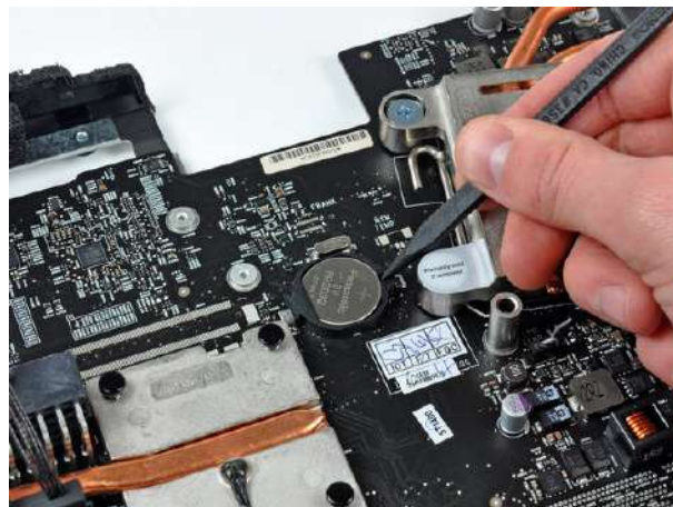
Abbildung 65 – Austausch Batterie Motherboard 213
