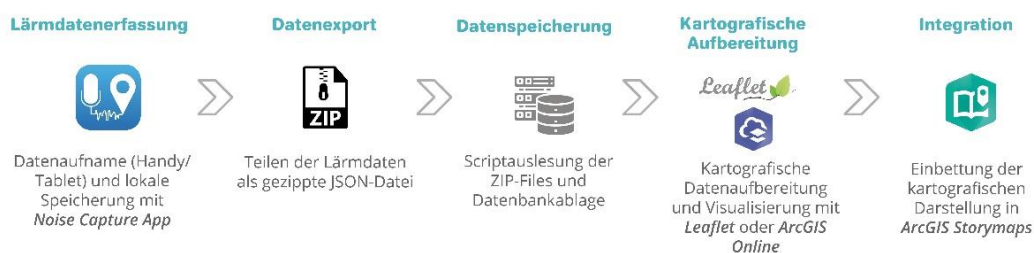
Abbildung 27: Vorschlag zum künftigen Ablauf von der Lärmdatenerfassung bis hin zur Visualisierung und Integration ins Präsentationsformat des Lärmmoduls. Quelle: eigene Darstellung
