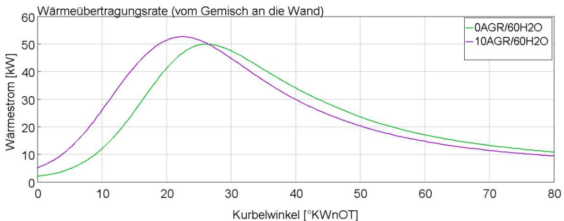
Abbildung 4.28 Wärmeübertragungsraten für Untersuchungsstelle mit 60 m%-Wasser mit und ohne AGR
