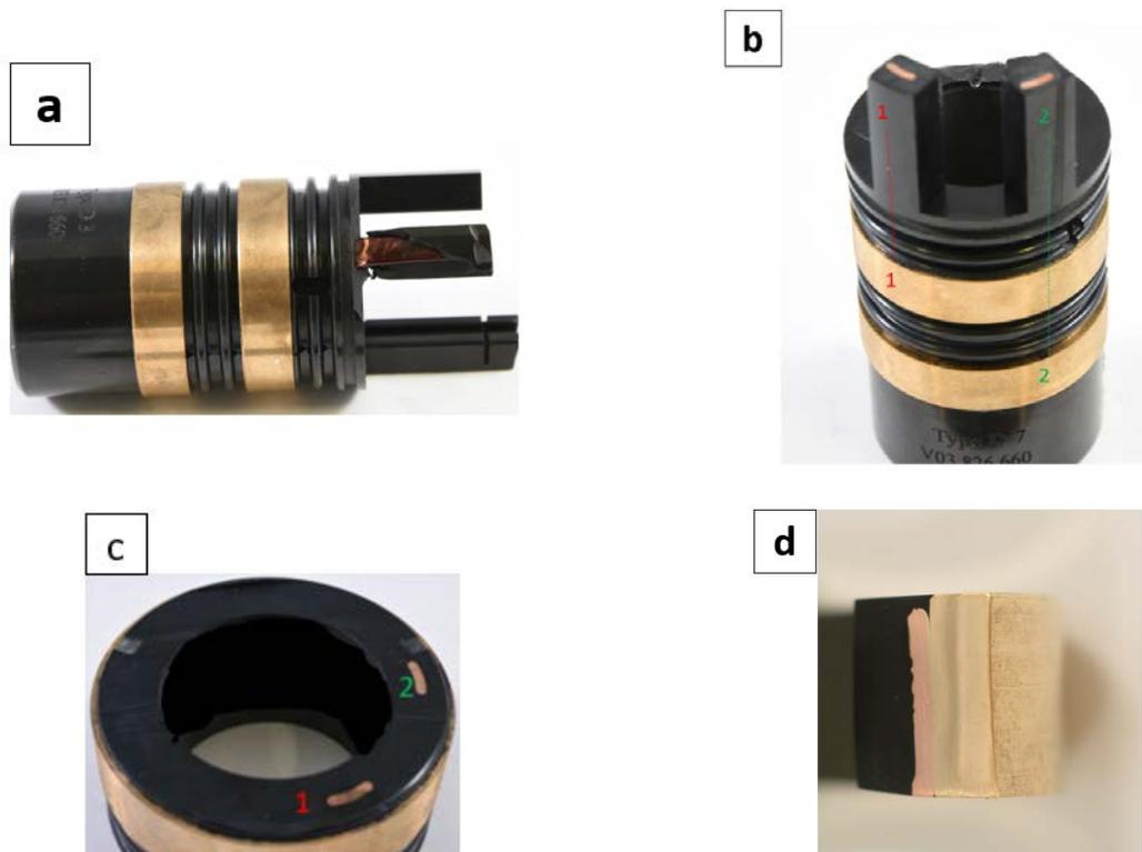
**Abbildung 4:** Gegenüberstellung industriell gefertigter Schleifring (a) Industriell gefertigter Schleifring in der Seitenansicht, (b) Schleifring mit Kontakten zu den jeweiligen Ringen. (c) Querschnitt durch Ring mit eingebetteten Kontakten, (d) mit Ring verlöteter Kontakt im Querschnitt.
