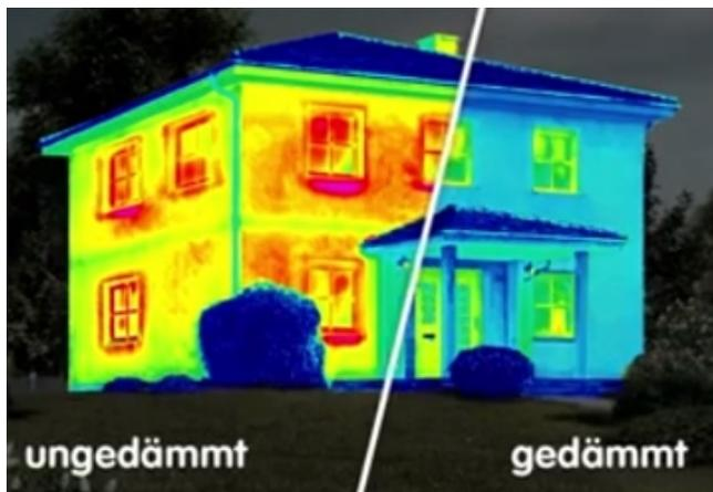
Abbildung 51: Vergleich von ungedämmten zu gedämmten Wänden mit einer Wärmebildkamera
