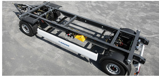
Abbildung 6: Wechselbrückenfahrzeug, Modell „Profi Box Carrier B7* 35 “
