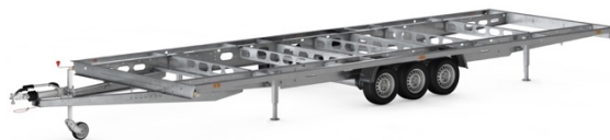
Abbildung 5: Abgewandelter Bootsanhänger, „Chassis für Tiny Houses“ 33
