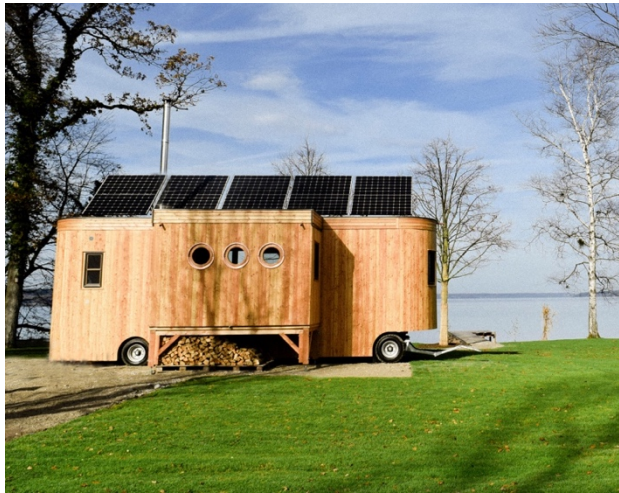
Abbildung 59: Tiny House mit 10 Stück südwärts orientierten Photovoltaikpaneelen 98
