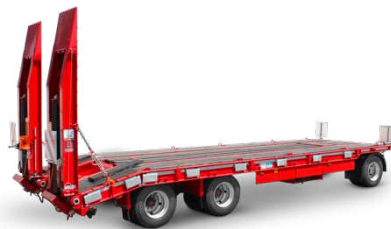
Abbildung 7: beispielhaftes Fahrgestell für den Transport von Tiny Houses, 3 – Achs Tiefladeanhänger mit geradem Plateau 37
