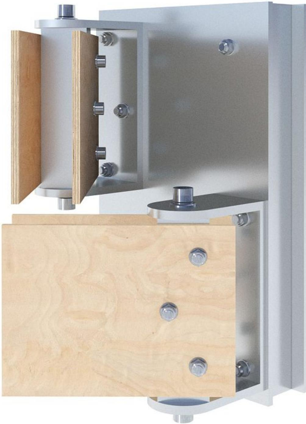
Abbildung 95: Visualisierung Standard Detail Anschluss Randträger- Spanten (MW, 2020).
