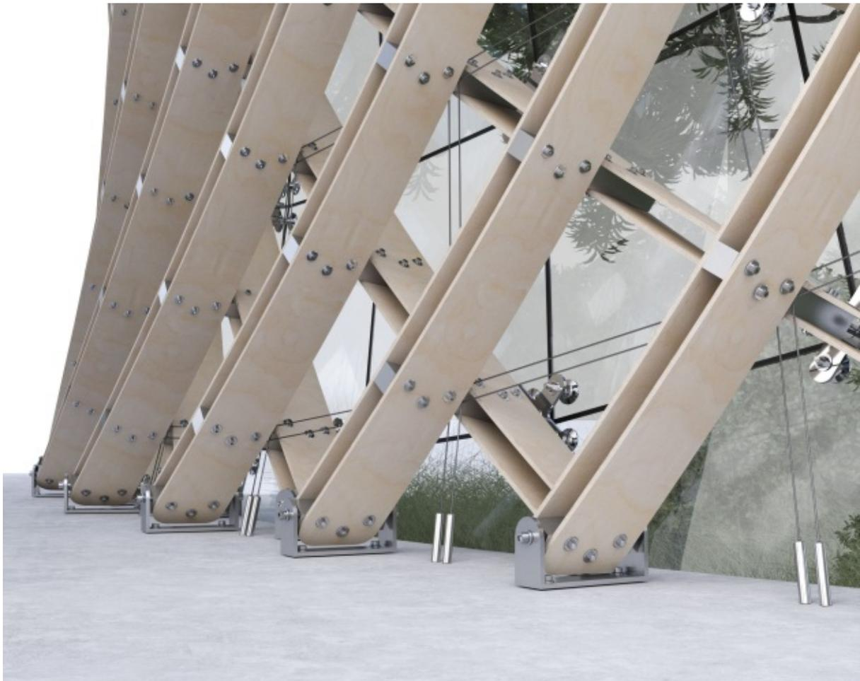
Abbildung 92: Visualisierung Standard Detail Anschluss Randträger in Gesamtstruktur (MW, 2020).
