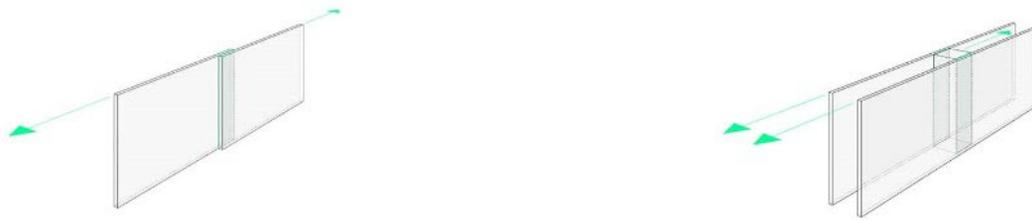
Abbildung 113: Links: Einschnittige Verbindung. Rechts: Zweischnittige Verbindung (MW, 2020).
