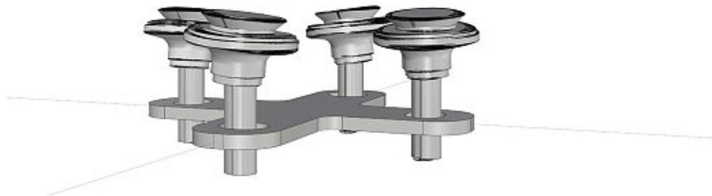
Abbildung 89: Visualisierung der individuellen Rotationen der Punkthalter (MW, 2020).
