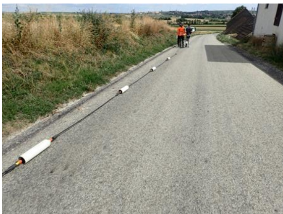
Abbildung 24: Messung mit dem "Ohm-Mapper", Quelle: NÖ Straßendienst
