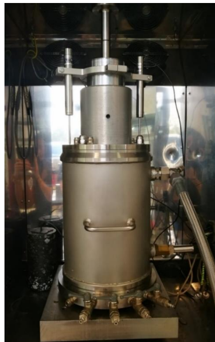
Abb. 4.6: Prüfeinrichtung des TCCT
