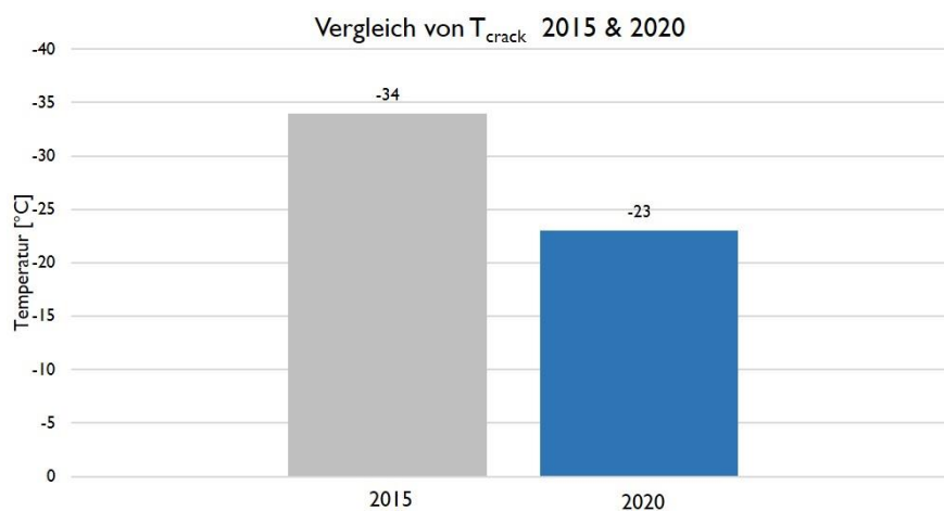
Abb. 5.11: Vergleich der Bruchtemperaturen 2015 und 2020
