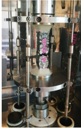
Abb. 4.3: Rissausbildung des Probekörpers
