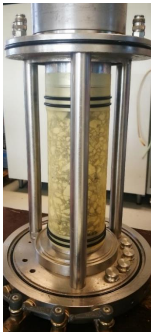
Abb. 4.5: Einbau des Probekörpers zwischen zwei Lastplatten, umhüllt von einer Membran
