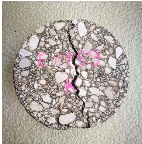
Abb. 4.11: Bruchbild eines Probekörpers nach dem IT-CY Versuch
