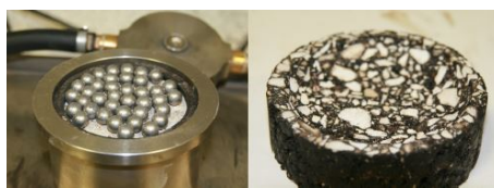
Abb. 2.11: Abrieb eines Probekörpers mittels Stahlkugeln [3]
