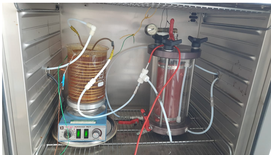
Abb. 4.1: VAPro: Blick in den Wärmeschrank mit Ölbad (links) und Druckzelle (rechts)
