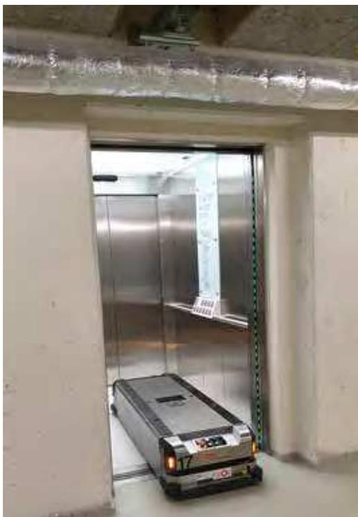
Abb.30 Der Roboter bucht sich eigenständig einen Aufzug
