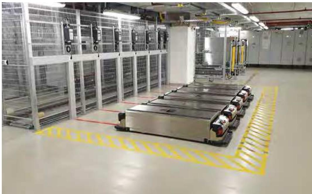
Abb.32 Ladestation des automatisierten Transportsystem
