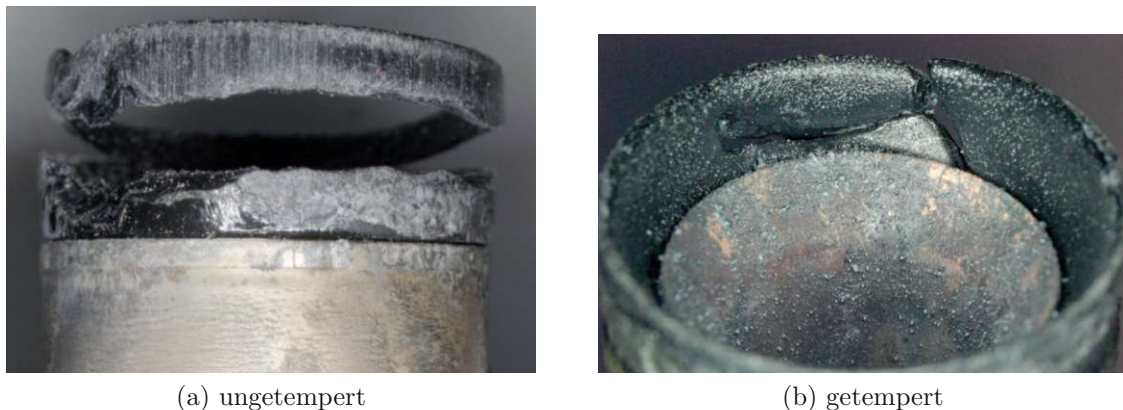
Abbildung 5.6.: Bruchbild von Kolbenaufsätzen aus Grivory HT3Z
