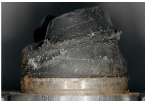
Abbildung 5.5.: Schadensbild eines TPE (Basis PP) Kolbenaufsatzes nach Leistungsüberprüfung mit Ergebnis: gut
