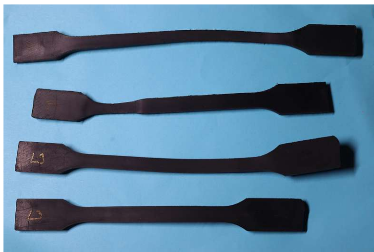
Abbildung C.4.: Zugprüfkörper (v.o.n.u.): TPE (PP-Basis) Raumtemperatur, TPE (PP-Basis) -40°C, TPE (PS-Basis) Raumtemperatur, TPE (PS-Basis) -40°C
