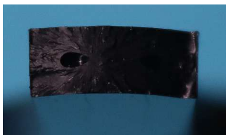
Abbildung C.5.: Bruchfläche im Zugversuch von Grivory HT3Z
