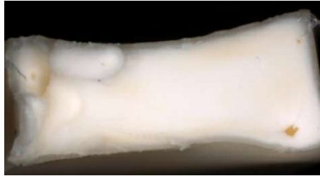
Abbildung C.1.: Bruchfläche im Zugversuch von PA6+ABS mit kleiner Einfallstelle (rechts unten im Bild)
