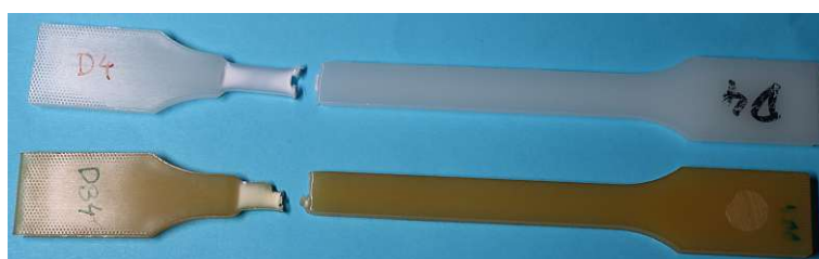
Abbildung C.6.: Bruchverhalten im Zugversuch von PA12 bei -40°C ungealtert (oben) 150h bei 120°C + 2000h bei 110°C (unten)
