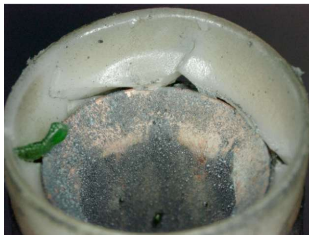
Abbildung 5.18.: Gebrochener Kolbenaufsatz nach 150h bei 120°C bei Leistungsanforderung gemessen bei -40°C
