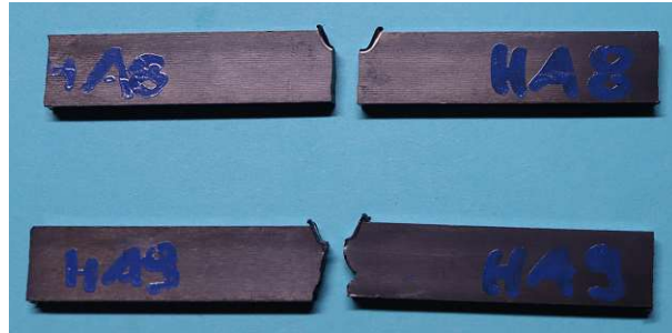
Abbildung D.1.: Unterschiedliche Bruchmechanismen bei Kerbschlagbiegeversuch Zytel HTNFE8200
