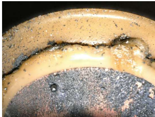
Abbildung 5.2.: Schadensbild im Inneren des Kolbenaufsatzes ohne Einfluss auf die Performance
