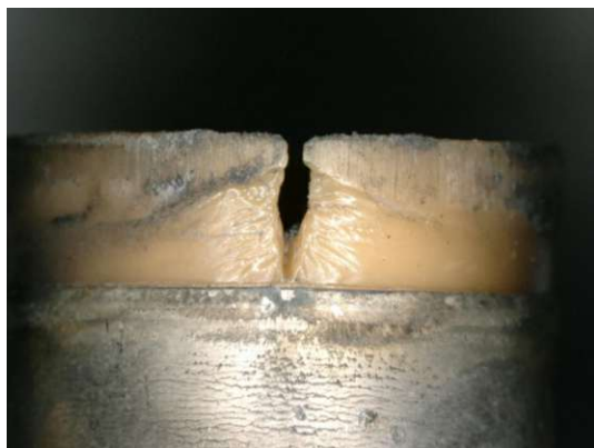
(a) Bindenahttriss mit geringfügigem Einfluss auf die Leistungsüberprüfung
