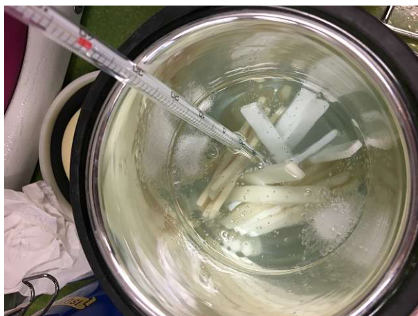
Abbildung 3.5.: Kältebad zum Temperieren von Kerbschlagbiegeproben
