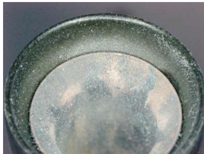
Abbildung 5.15.: Intakter Kolbenaufsatz aus Zytel HTNFE8200 nach thermischer Alterung trotz Leistungsverlust
