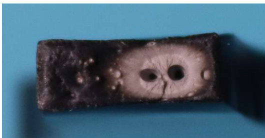
(a) Zugprüfkörper mit Lunker
