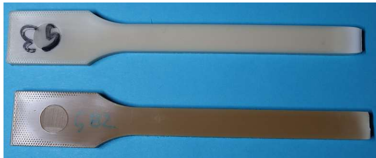
Abbildung C.8.: Optische Alterungserscheinung durch Verfärbung bei Polyamid 66 (Zytel ST801)
