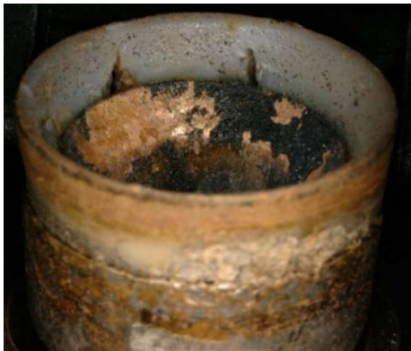
Abbildung 5.3.: Bruchbild eines Kolbenaufsatzes aus PA6+ABS
