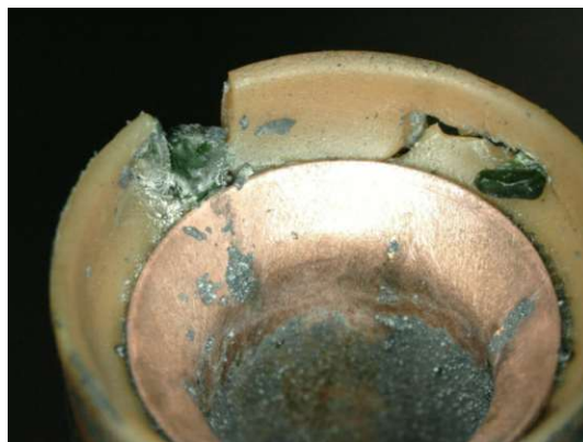
(b) Bruchbild nach einer thermischen Alterung von 150h bei 120^{\circ}\text{C} und 1500h bei 110^{\circ}\text{C}
