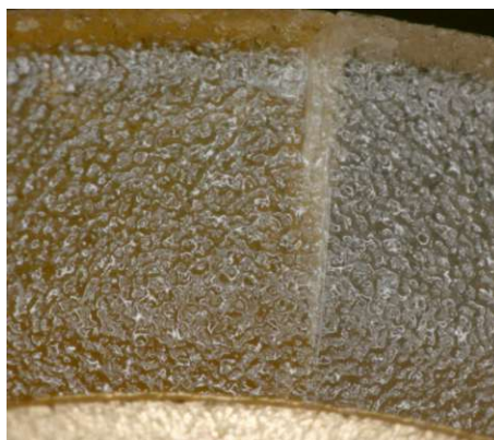
Abbildung 5.8.: Gespritzter Kolbenaufsatz aus PA12 mit eindeutigen Spritzfehlern
