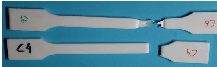
Abbildung C.3.: Bruchfläche im Zugversuch von Polybutylenteraphtalat bei Raumtemperatur (oben) und -40°C (unten)
