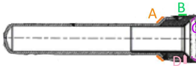
Abbildung 5.1.: Positionen an denen der Temperaturmesslack angebracht wurde
