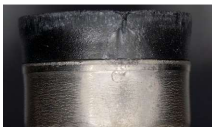
Abbildung 5.10.: Schadensbild bei PA6.6 Grilon AZ3 Kolbenaufsatz bei guter Leistungsperformance, getestet bei -40^{\circ}\text{C}
