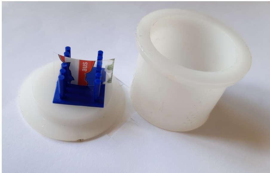
Abbildung 3.7: Aufbau Materialprobe in der Probenhalterung
