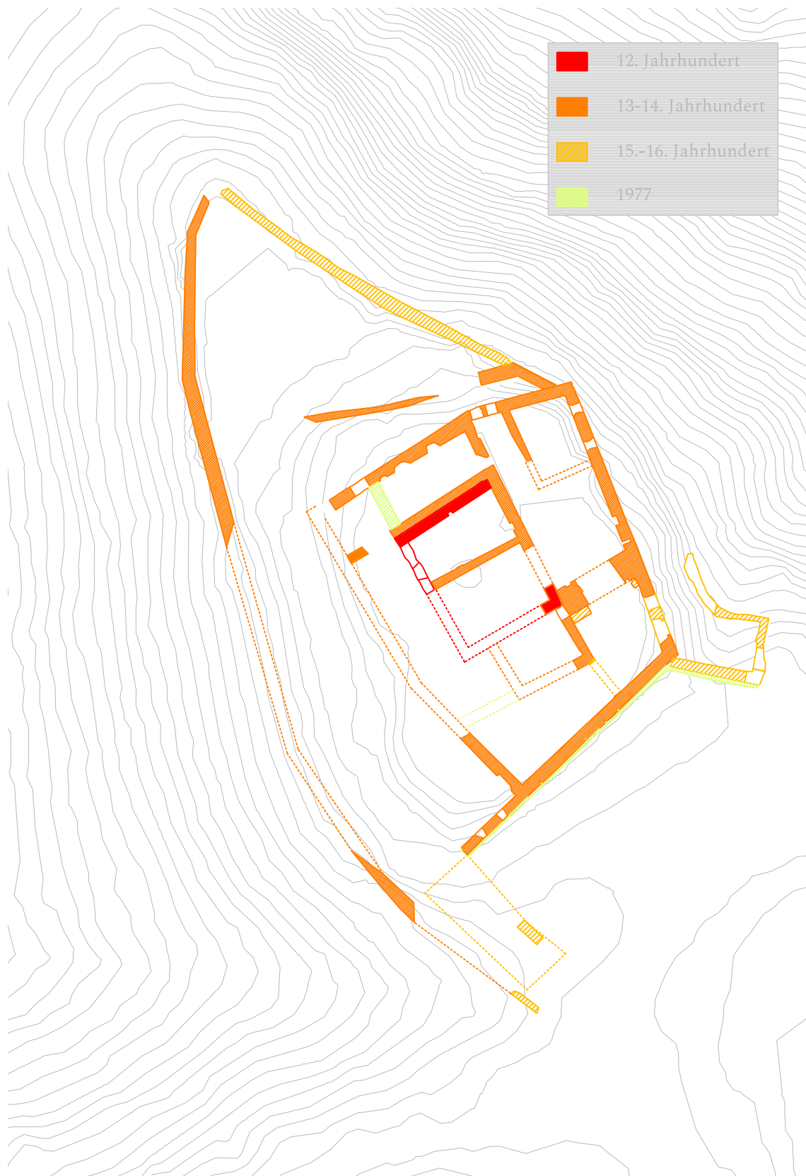
Abb.44: Mauerwerksdatierung der Erdgeschosszone
