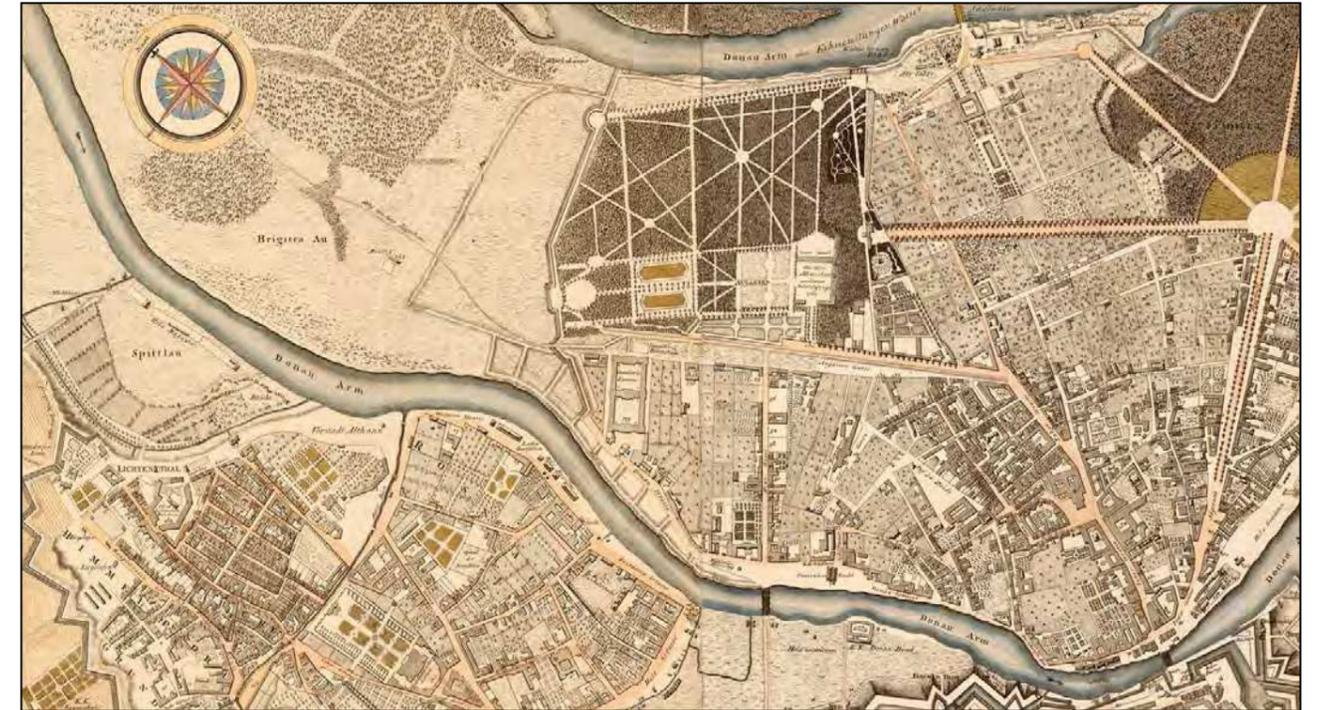
Abb. 44. Karte von Wien und Umgebung von Max von Grimm 1796 (Ausschnitt). Zu erkennen ist das Dammsystem vom Prater entlang des Fahnenstangenwassers, nördlich des Augartens und entlang des Donaukanals. Nebenbefundlich Dämme im Bereich von Spittelau. Die genaue Zeit der Errichtung der Dämme ist nicht eruiert.
