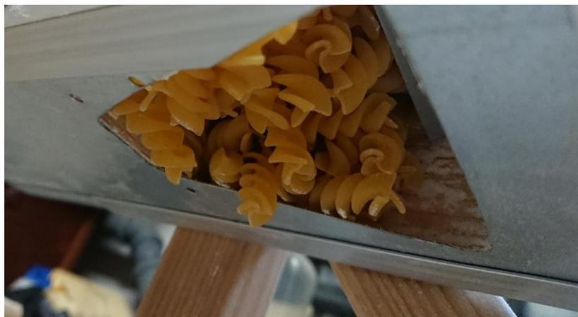
*Abbildung 61: Verkeilen der Spiralnudeln in der Schiebepplattenöffnung*
