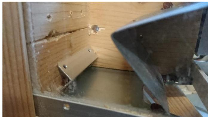
*Abbildung 67: Zusätzliches Leitelement in der Spendereinheit*
