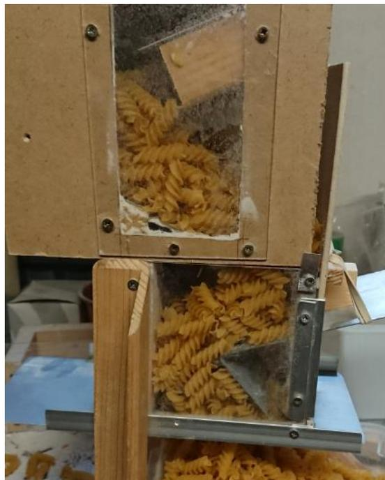
*Abbildung 62: Versuch mit Spiralnudeln mit flachen Leitelementen*
