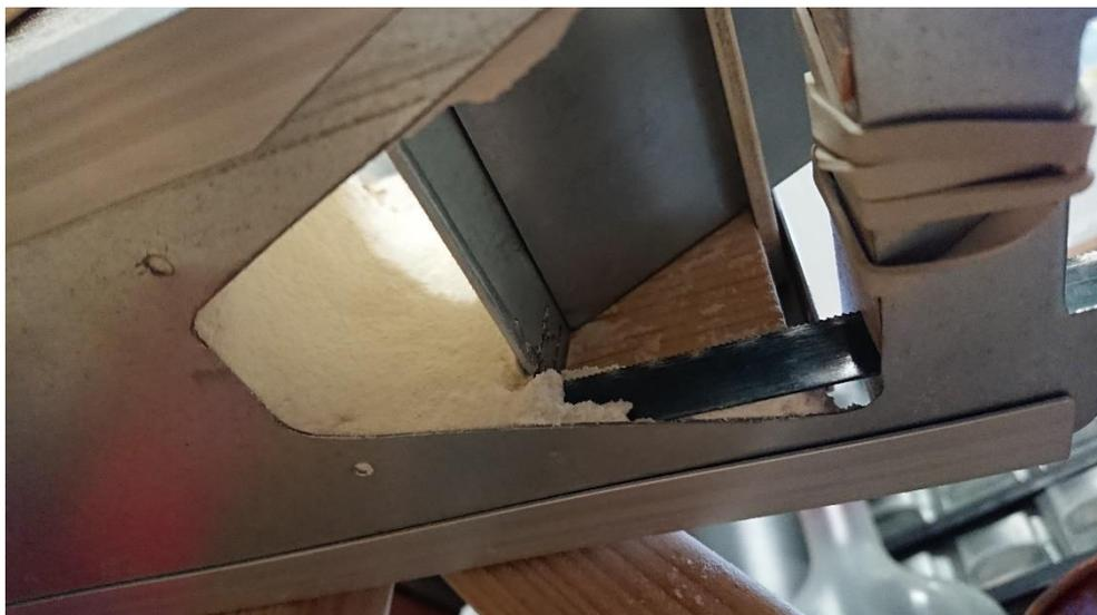
*Abbildung 51: Test der Agitation durch Vibration des Leitblechs mittels Sägeblatt*
