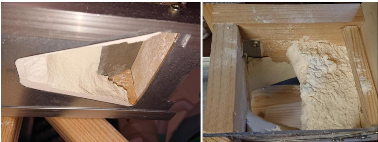
Abbildung 50: Brückenbildung in Entnahmeöffnung (li.), Schlotbildung nach schwallartigem Austritt (re.)
