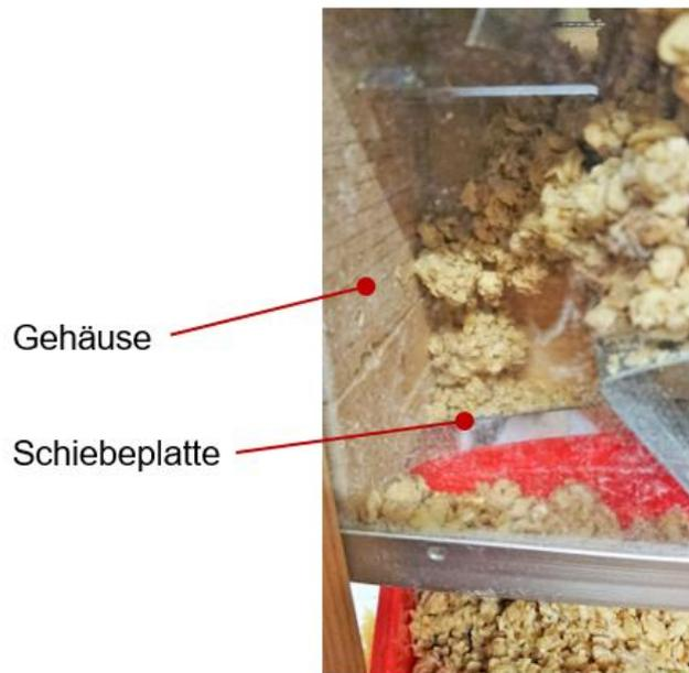
*Abbildung 66: Verhaken des Knuspermüslis in der Dosiereinheit*
