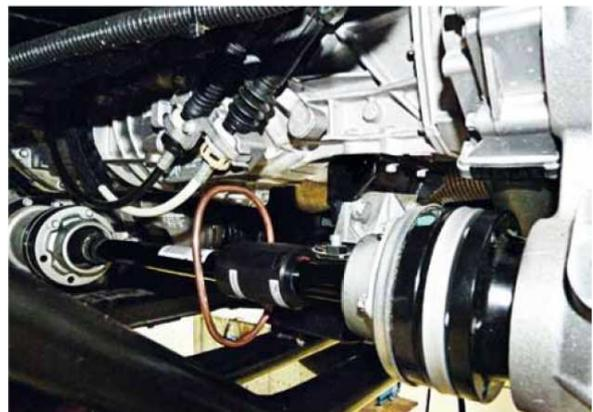
Abbildung 20: Ein System für die Messung der mechanischen Leistung mit induktiver Spannungsversorgung am Fahrzeug [19].
