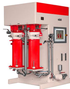
Abbildung 1: Eine moderne Variante der Doppelkammer-Perlmühle von Vollrath [35]. Im Betrieb sind derzeit viel ältere Modelle.
