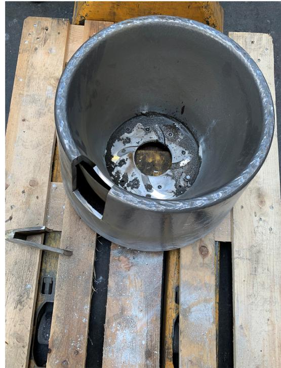
Abbildung 9: Ein aufgeschnittener Rotor nach einer Fehlmessung
