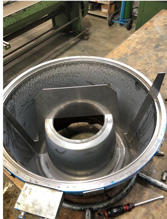
Abbildung 7: Profilschablone, die für die Abschätzung des Statorverschleißes benutzt wird.
