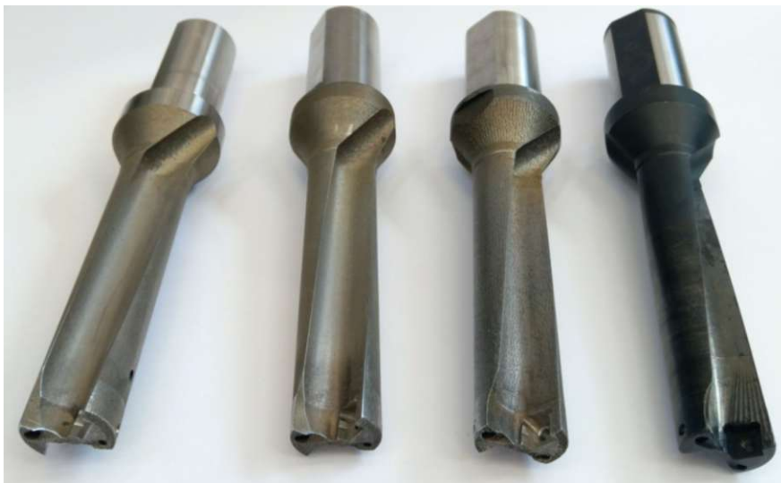
Abb. 2.14: Wendeplattenbohrkörper im Vergleich: additiv hergestellt (ersten drei von links) und handelsüblich (rechts) [39]
