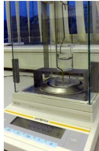
Abbildung 4-6 Versuchsaufbau der Dichtemessung
