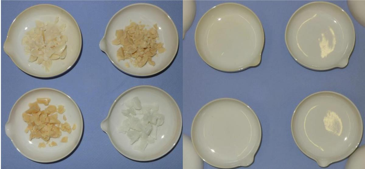
Abbildung 5-27 linkes Bild: Keramikschalen mit den Proben KABL, KALC, KBLC und KBBL (von li. ob. im Uhrzeigersinn) rechtes Bild: Probengefäße nach Muffelofen (selbe Probenanordnung wie im linken Bild)
