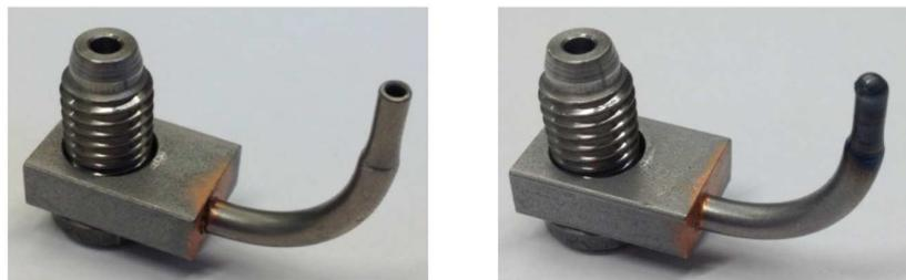
**Abbildung 7.3:** Links: Kolbenspritzdüse; Rechts: verschweißte Kolbenspritzdüse
