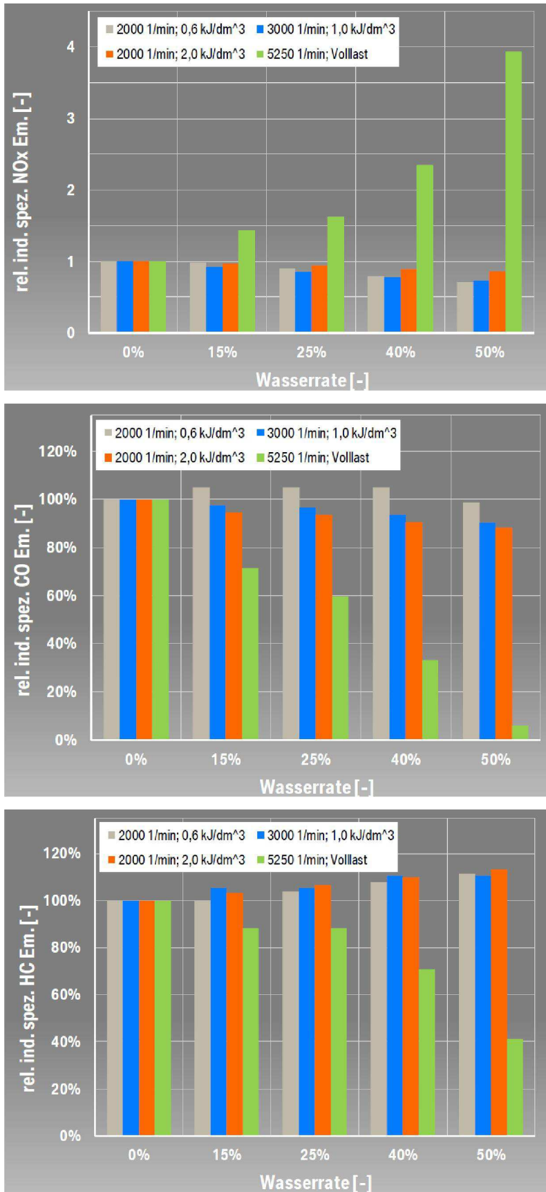
Abbildung 7: Auswirkung der Saugrohr-Wassereinspritzung auf die Rohemissionen eines Motors [2]
