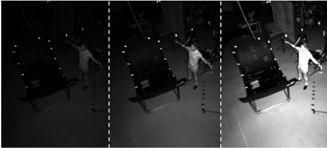
Abbildung 5.8: Vergleich verschiedener Thresholding-Werte: links – 1800, mittig – 550, rechts – 200
