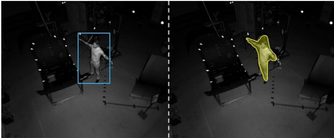
Abbildung 5.10: Ergebnisse von Mask R-CNN: links die ermittelte Bounding Box, rechts die Maske
