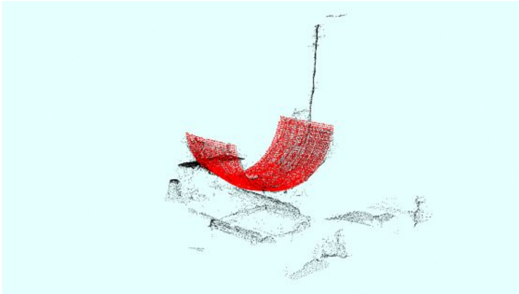
Abbildung 5.27: Erkannte Pose des Bauteils
