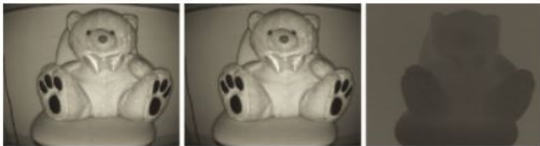
Abbildung 2.9: Darstellung der Amplituden(links), Intensitäten(Mitte) und der Depth-Map(rechts) [31]
