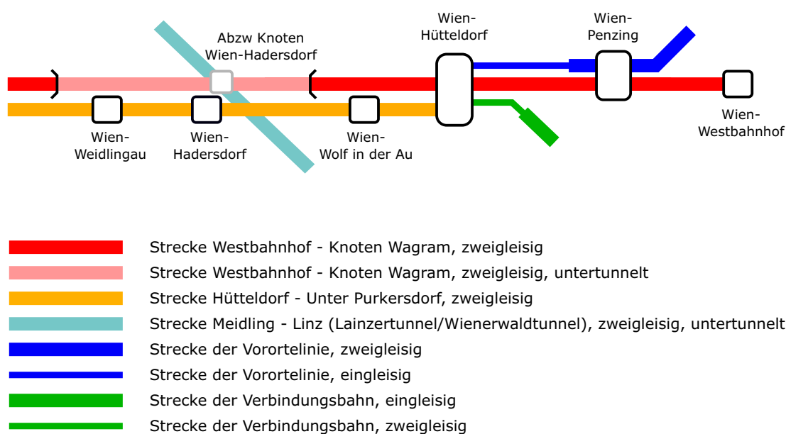
Abb. 3.1: Streckenverläufe durch und um den Knoten Hütteldorf
