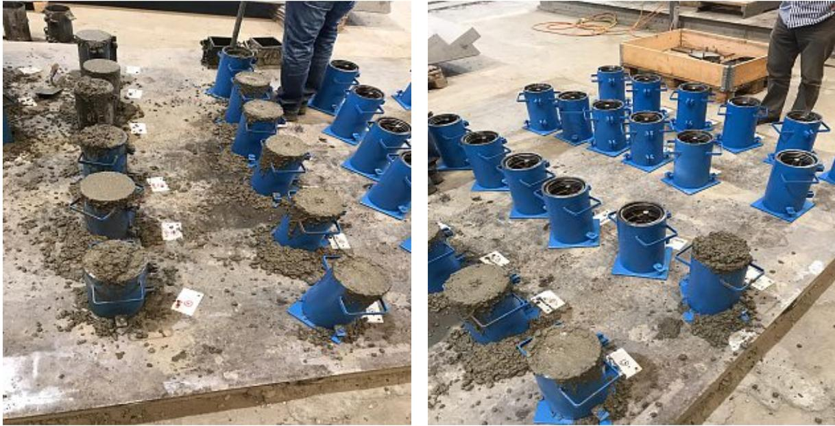
Abb. 3.5: Betonieren der Versuchskörper in der Firma Oberndorfer GmbH & Co KG
