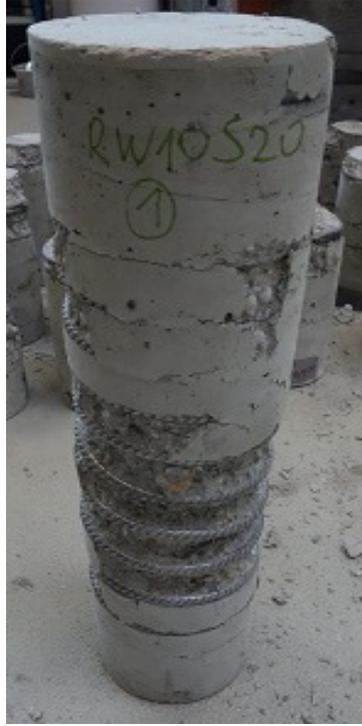
**Abb. 4.3:** Versuchskörper der Serie RF1 mit einem hochfesten Vergussmörtel
