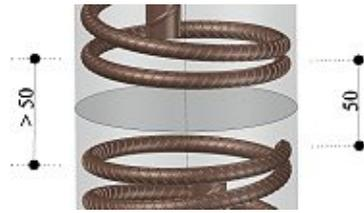
Abb. 4.10: Ermittlung des maßgebenden Abstandes  $s_c$  für die Nachrechnung der Versuche
