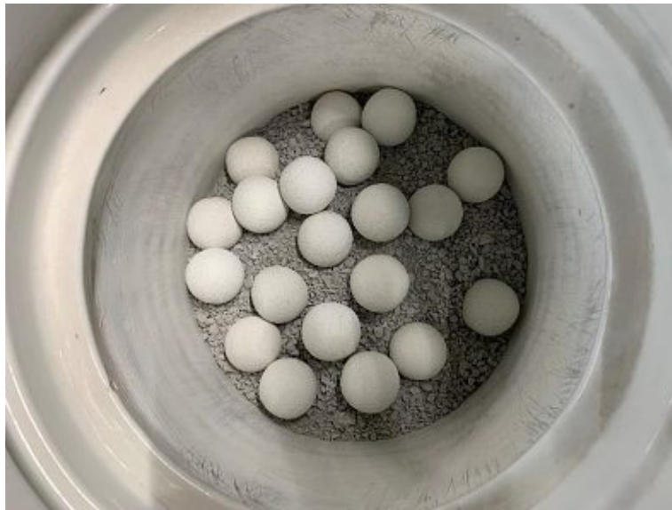
Abbildung 3.7: Mahlgut (gebrochener, hydratisierter Zement) und Mahlkörper vor dem Mahlvorgang
