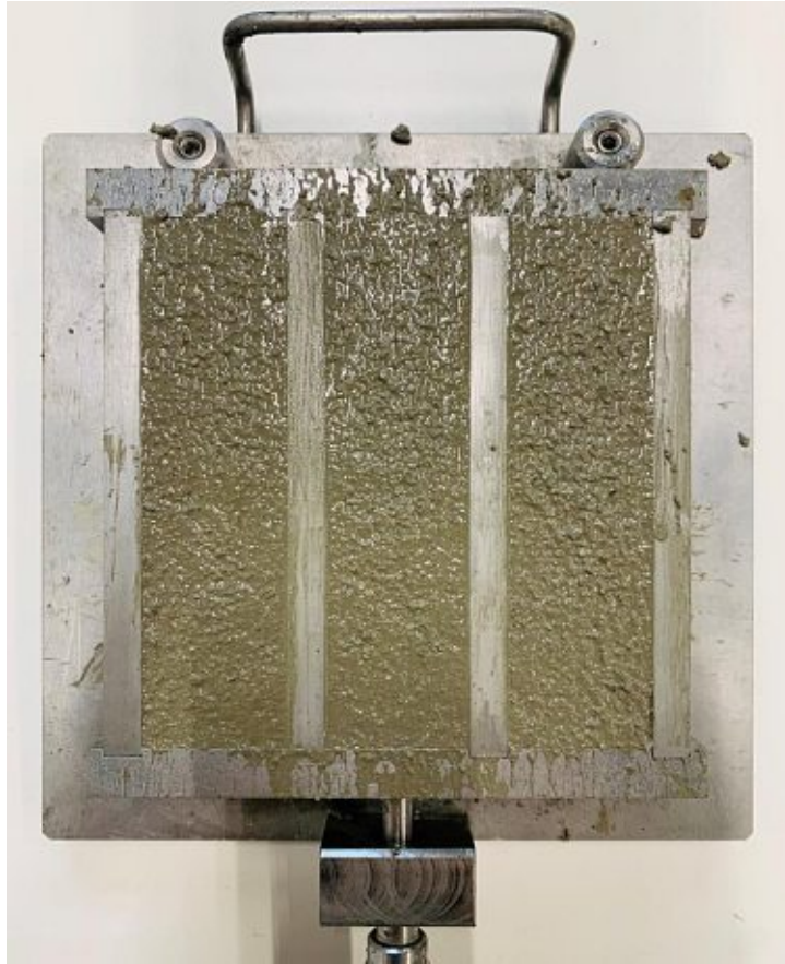
Abbildung 3.5: Frischmörtel in Schalung eingebracht
