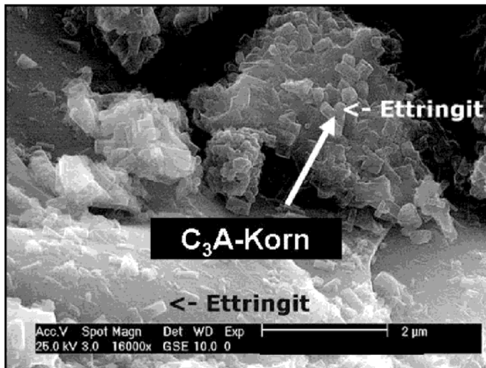
Abbildung 2.3: Primäre Ettringitbildung auf C_3A -Korn [25]
