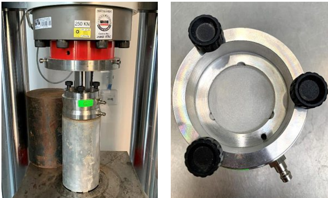
Abbildung 3.11: Edelstahlödometer eingebaucht in Druckmaschine (links), verdichtete Gips-Zement-Probe (rechts)
