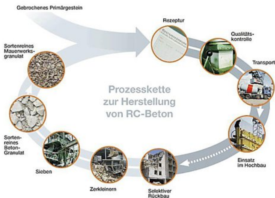
Abbildung 2.8: Die Prozesskette zur Herstellung von RC-Beton [15]
