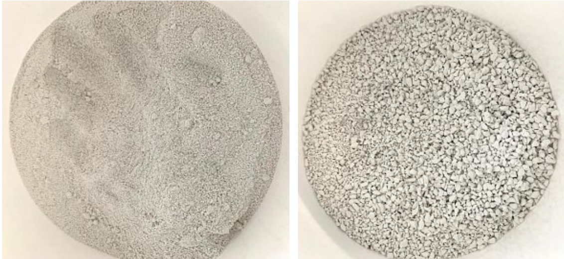
Abbildung 3.3: feinkörniger Gips (links), grobkörniger Gips (rechts)
