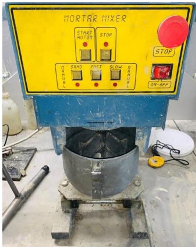
Abbildung 3.4: Mörtelmischer mit Schüssel und Rührer
