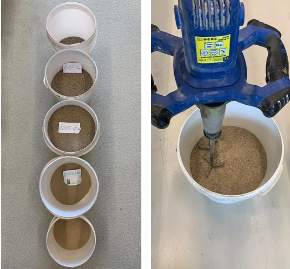
Abbildung 3.2: Die unterschiedlichen Kornfraktionen (links), fertiger Zuschlag (rechts)
