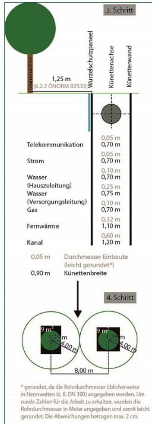
Abbildung 43: Schematische Darstellung der Einbauten-Mindestabstände für Wurzelschutzpaneele; Quelle: ÖNORM
