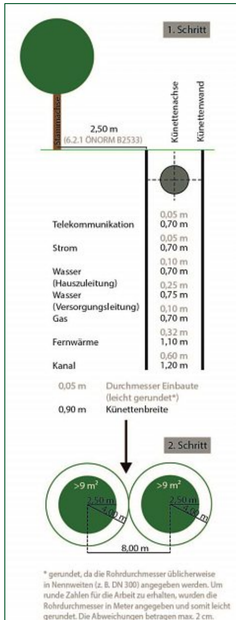
Abbildung 40: Schematische Darstellung der Einbauten-Mindestabstände; Quelle: ÖNORM
