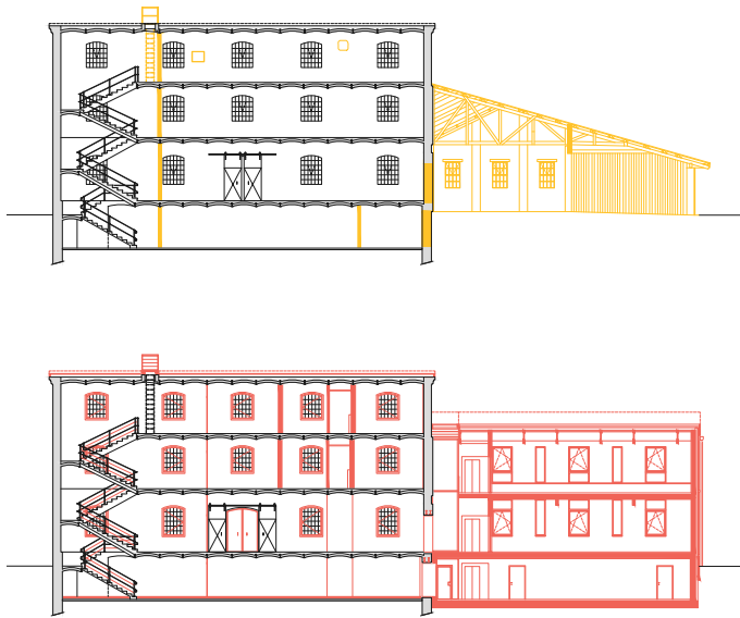
Abb. 208: Schnitt A-A, Abbruch / Neubau, M 1:500
