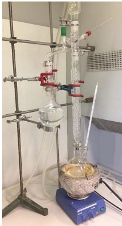
Abbildung 13: Rektifikationskolonne mit Vigroux-Kolonne und Rücklaufteiler
