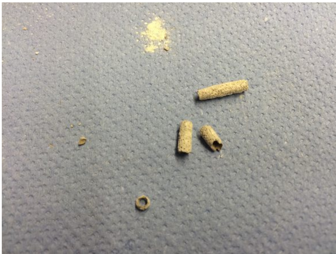
Abbildung 44: Ringspalt bestehend aus Katalysator, Koks und Salz
