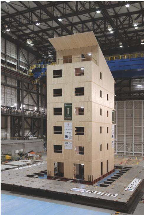
141 Erdbebensicherheitstest an einem CLT-Gebäude in Japan
