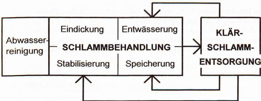
**Abb. 2: Anforderungen der Klärschlammentsorgung an die einzelnen Stufen der Schlammbehandlung**
