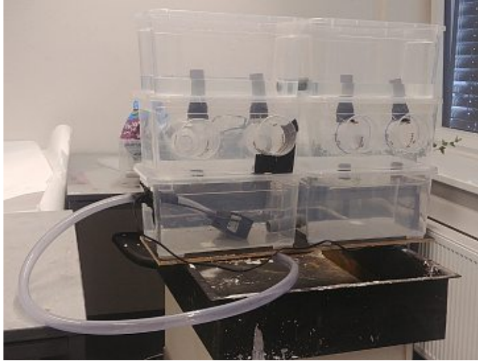
Abb. 82: kleiner Systemcheck des Wasserlaufs mit sechs Modulen
