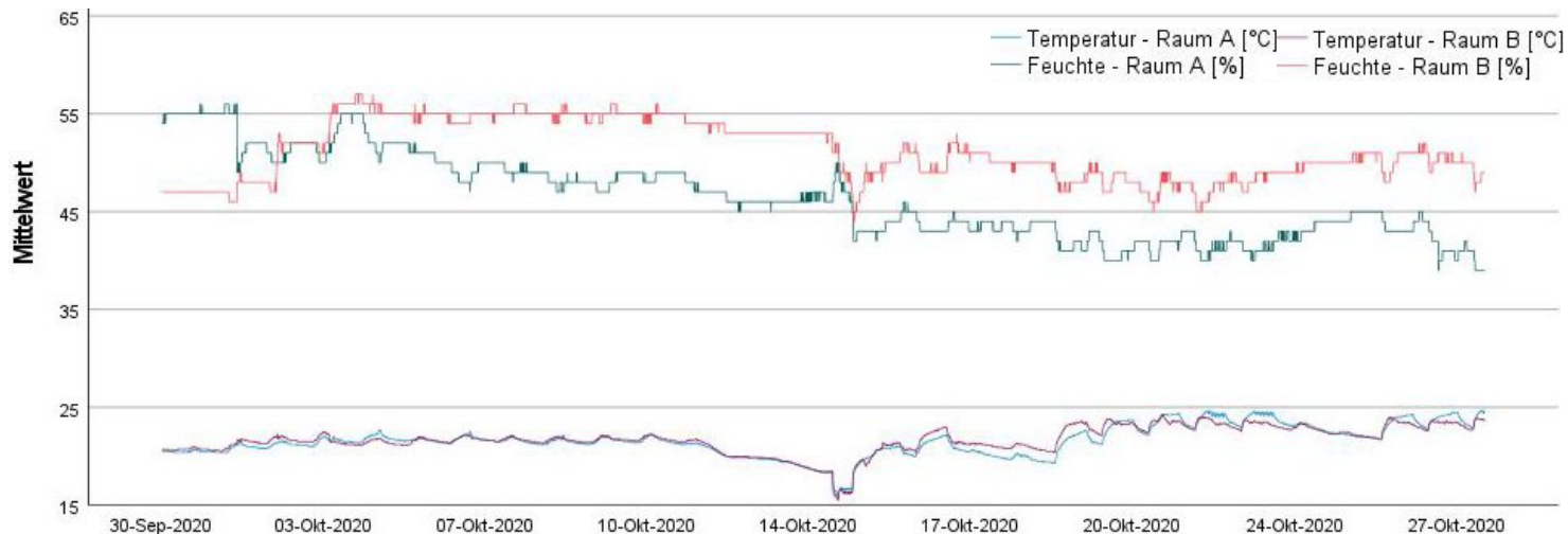
Abb. 57: Überblick über Temperatur und Feuchtigkeit in Raum A (nicht begrünt) und Raum B (begrünt) der zweiten Testperiode. Die Ordinatenachse entspricht °C bzw. %.
