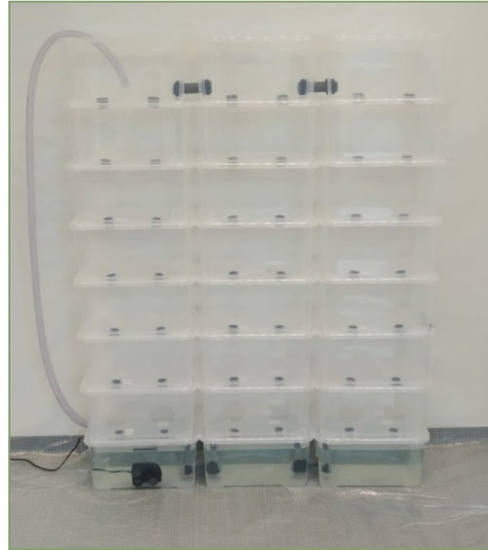
Abb. 27: der unbestückte Prototyp inkl. Wassertank und Pumpe
