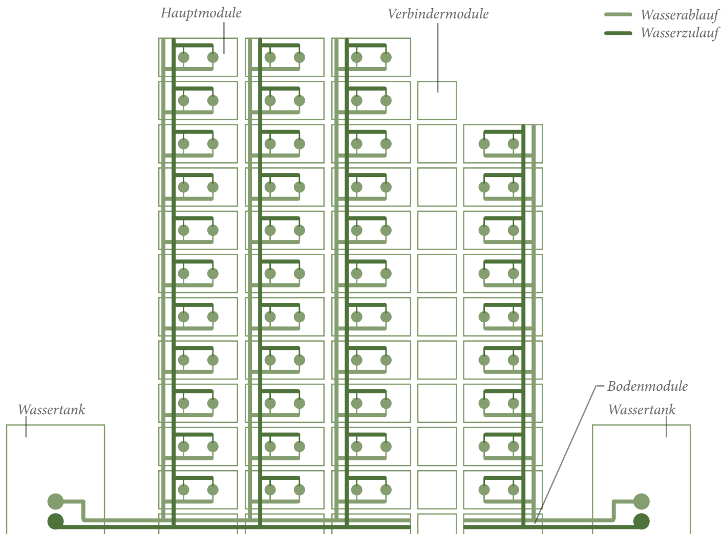
Abb. 122: Wasserflussdiagramm einer Aufbauvariante der Module
