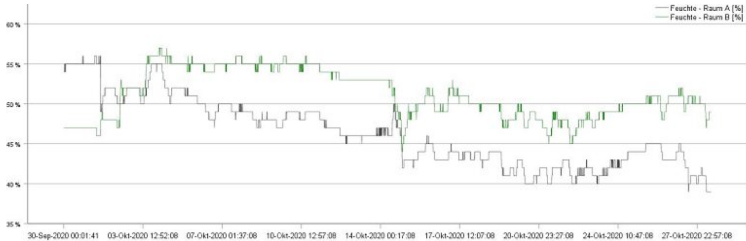
Abb. 61: Feuchtigkeitsverlauf von Raum A (nicht begrünt) verglichen mit Feuchtigkeitsverlauf von Raum B (begrünt).
