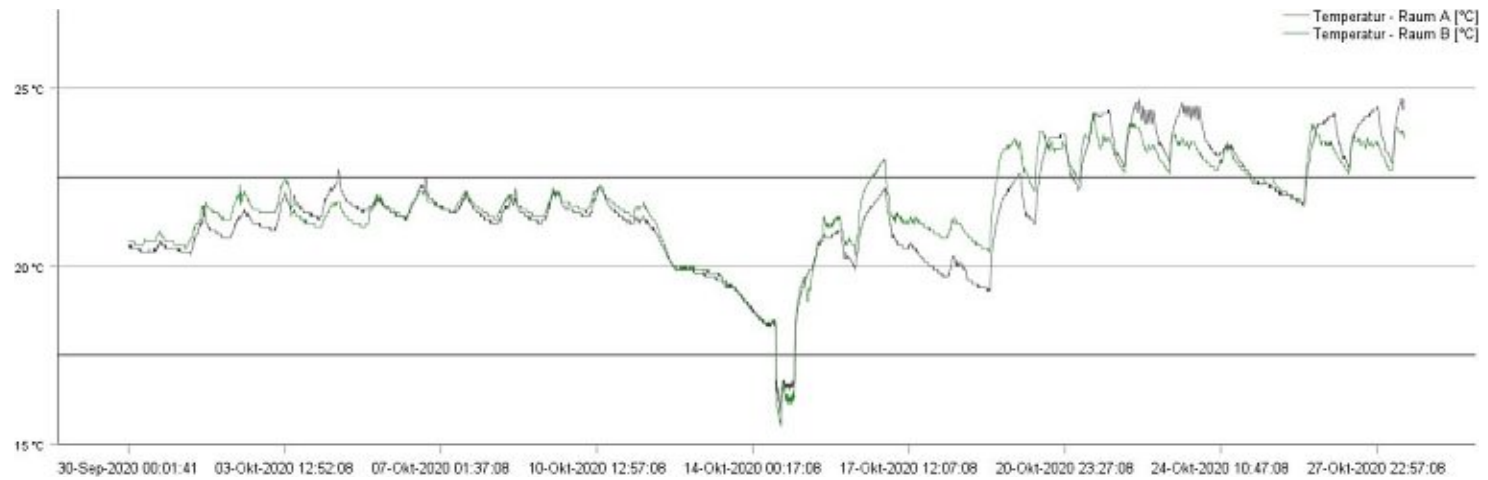
Abb. 60: Temperaturverlauf von Raum A (nicht begrünt) verglichen mit dem Temperaturverlauf von Raum B (begrünt).
