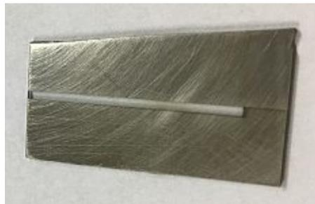
Abbildung 8.2: Doppelt beschichtetes Glas-Substrat mit einer  $\text{Fe}_{1,8}\text{Co}_{0,2}\text{VAI}$ -Schicht und einer  $\text{Fe}_{1,8}\text{Mn}_{0,2}\text{VAI}$ -Schicht mit einer Dicke von  $0,25\ \mu\text{m}$ .
