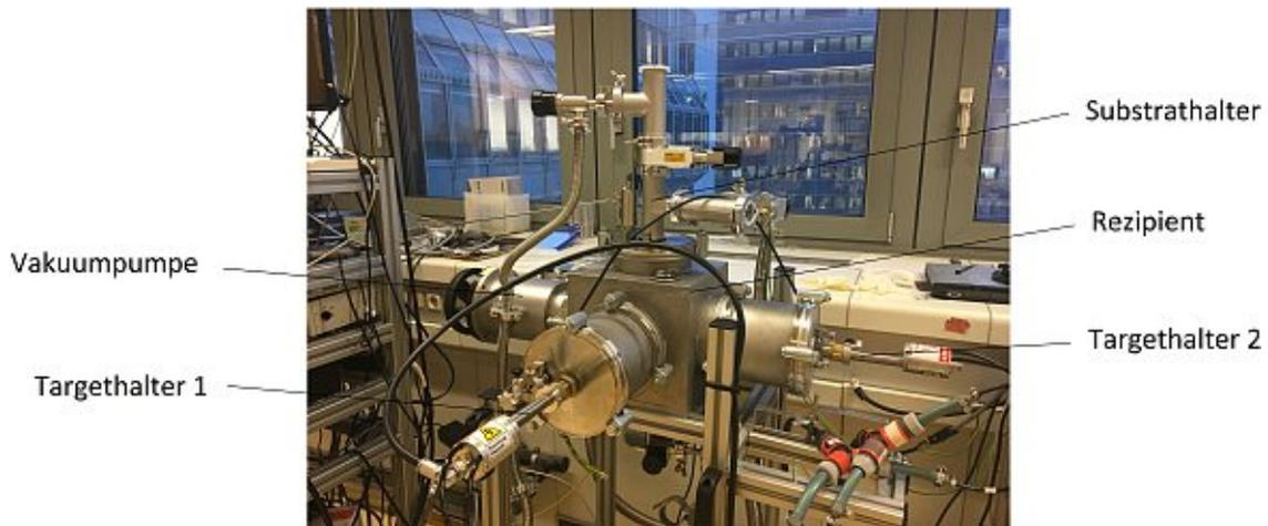
Abbildung 4.3: Verwendete Anlage zur Beschichtung der Substrate mittels Magnetron-sputtern. Das Substrat wird von oben in den Rezipienten eingeführt, das Target von der Seite. Der Pumpstand besteht aus einer Drehschiebepumpe mit vorangehender Turbomolekularpumpe.
