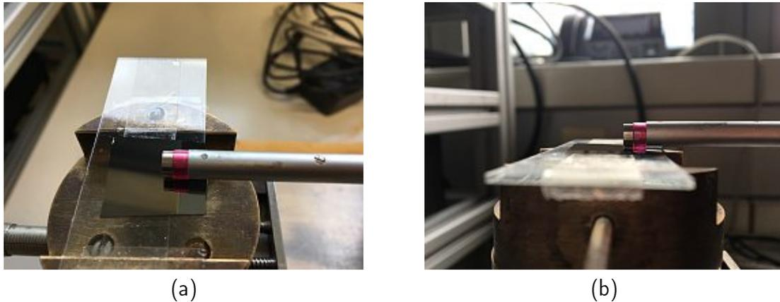
Abbildung 5.1: Profilmeter zur Bestimmung der Schichtdicke. (a) Ansicht von oben mit teilweise beschichtetem Substrat. (b) Ansicht von der Seite.
