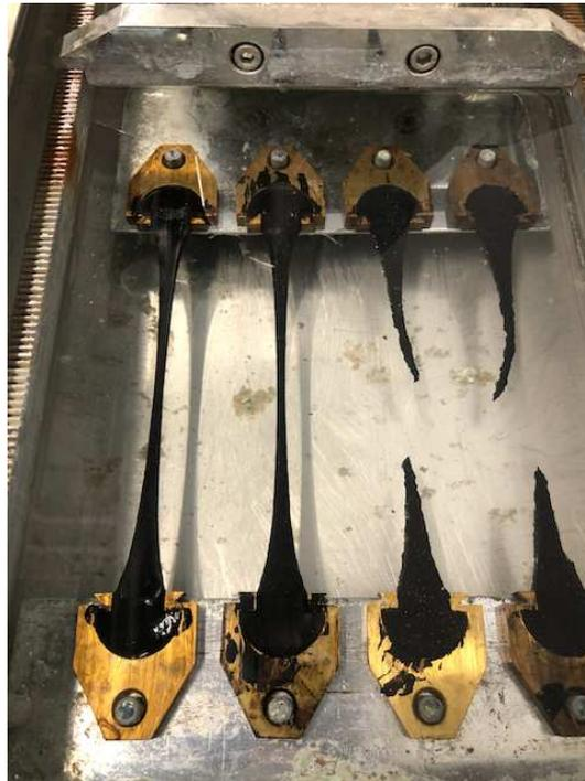
**Abbildung 21:** Versuchsdurchführung der Elastischen Rückstellung
