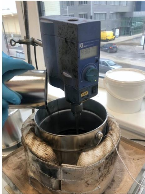
**Abbildung 8:** Veranschaulichung des Mischvorgangs zur Herstellung des RmB
