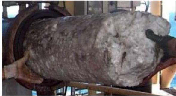
**Abbildung 2-21: Hydrat welches eine Rohrleitung verstopft [27]**
