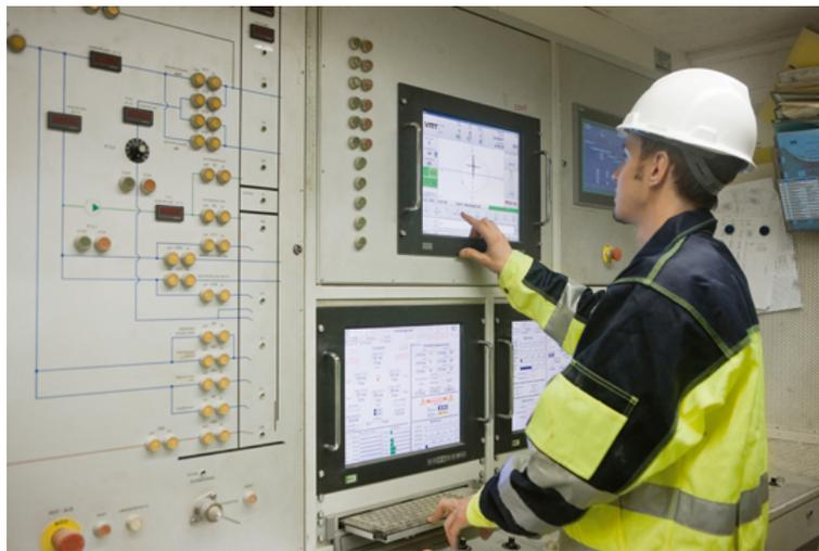
**Abb. 2.20:** Steuerstand einer Tunnelvortriebsmaschine (Quelle: Herrenknecht AG [32])
