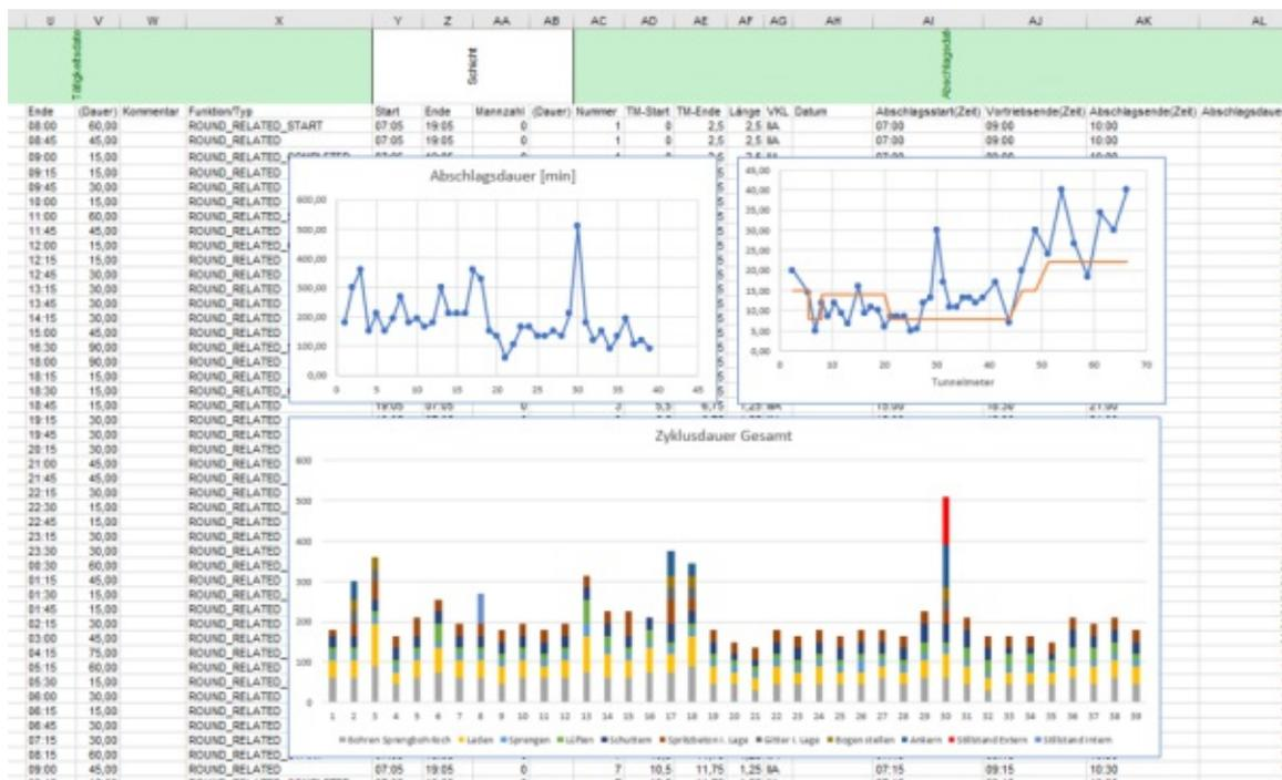
Abb. 4.4: Datenauswertung eines digitalen Zyklusdiagrammes mit MS Excel (Quelle: ITC Engineering GmbH & Co. KG [35])
