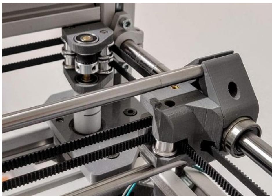
Abbildung 91 - Führungssache und Antrieb
