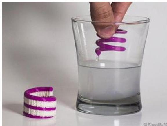
Abbildung 5 - Wasserlösliches Filament PVA [6]
