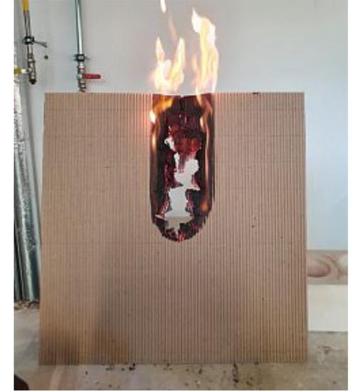
Abb. 4.159 Nachher- unbehandelte Wellpappenprobe
