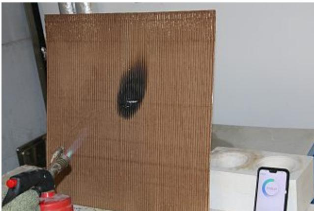
Abb. 4.157 Brandversuch- behandelte Wellpappenprobe
