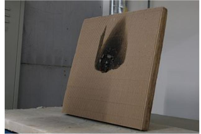
Abb. 4.167 Nachher- unbehandelte Wellpappenprobe 2
