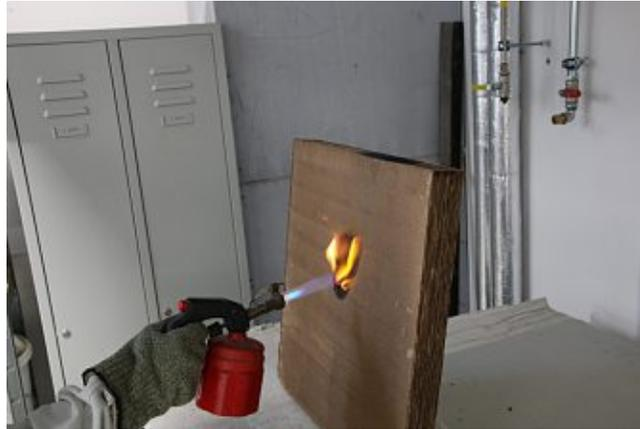
Abb. 4.164 Brandversuch 2 - behandelte Wellpappenprobe
