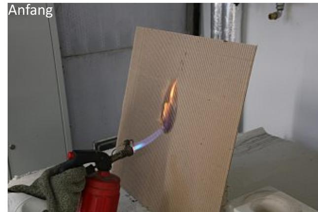
Abb. 4.154 Brandversuch- unbehandelte Wellpappenprobe
