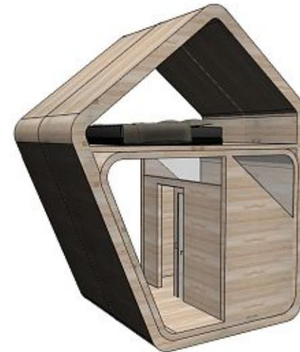
Zwei zusammengestellte je 1,20 Meter breite Module bilden zwei Etagen:
