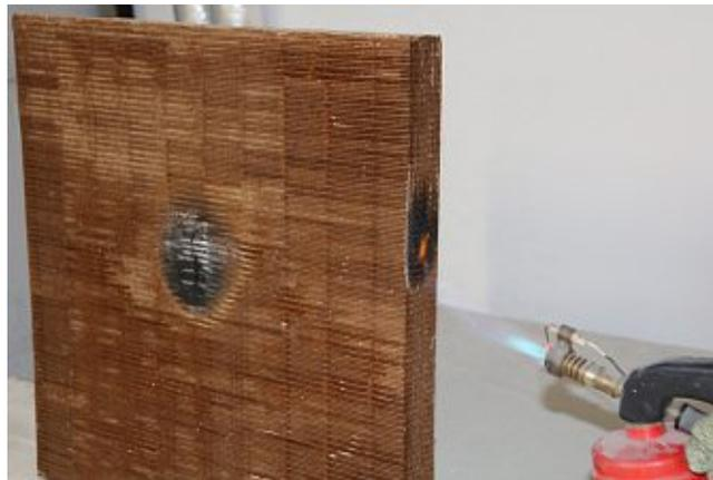
Abb. 4.165 Brandversuch 2 - unbehandelte Wellpappenprobe
