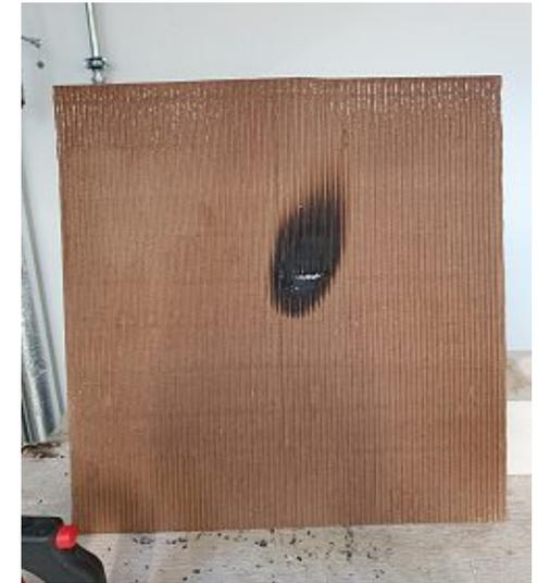
Abb. 4.161 Nachher- behandelte Wellpappenprobe
