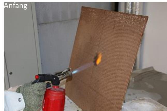
Abb. 4.155 Brandversuch- behandelte Wellpappenprobe
