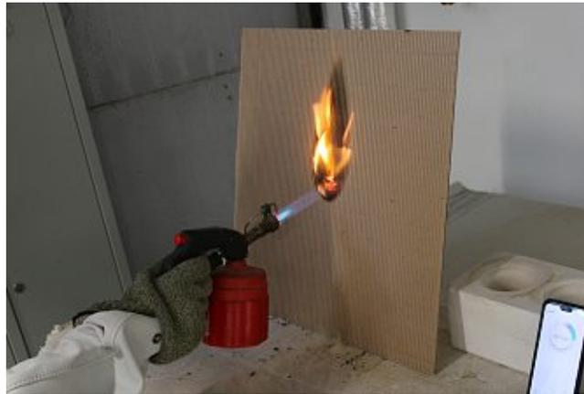
Abb. 4.156 Brandversuch- unbehandelte Wellpappenprobe
