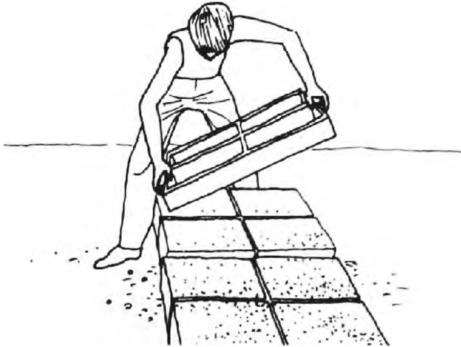
Abb.: 50 - Herstellung der Adobe Ziegel, Lehm wird in Holzform geformt und anschließend in der Sonne getrocknet
