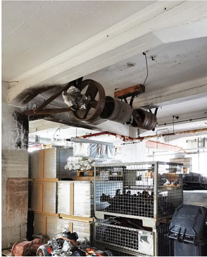
Abb.58: Letztes Stück der Transversalwelle zum Antrieb von Maschinen in der Zurichte I.
