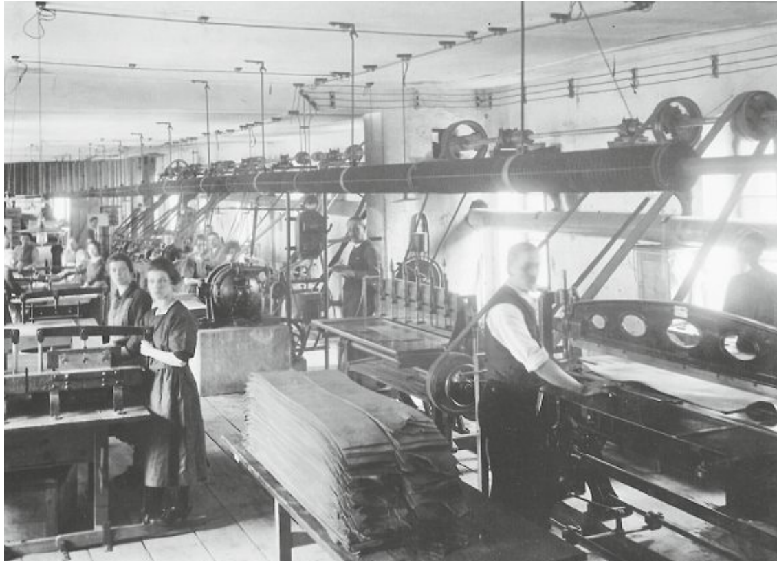
Abb.16: Beim Zurichten des Leders mit Hilfe spezieller Maschinen, zur Nachbehandlung des Leders nach dem Gerbprozess. Der Antrieb der Maschinen funktionierte über an der Decke laufende Transversalwellen und Lederriemen.
