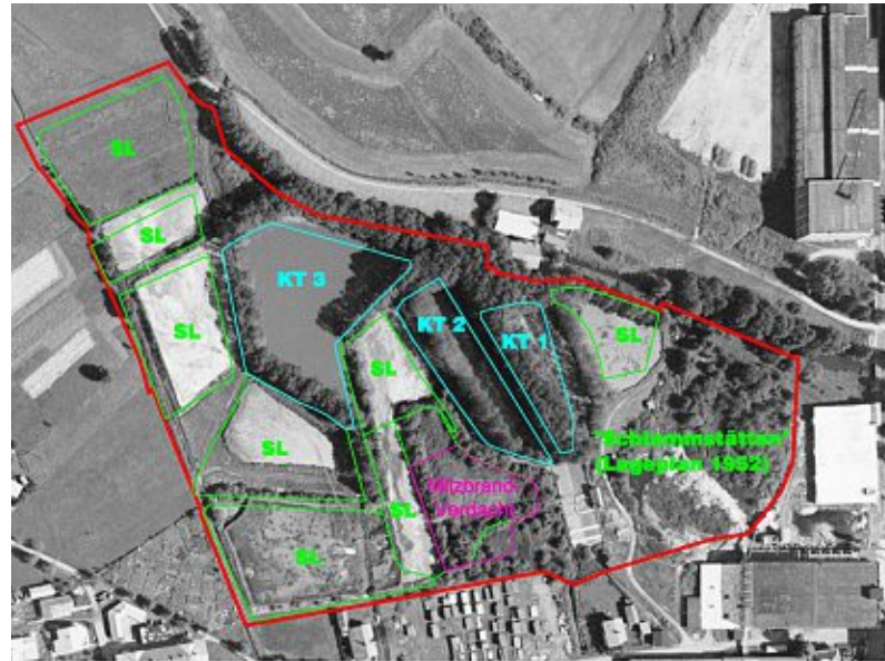
Abb.7: Luftbild der Schlammeiche aus dem Jahr 1963. Gekennzeichnet sind die Klärteiche und Schlammlager.
