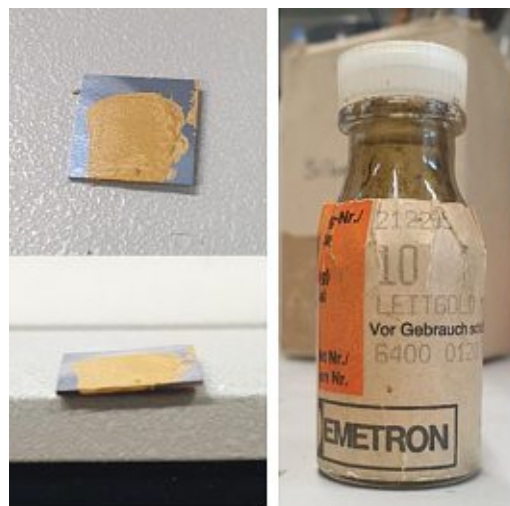
Abbildung 20: Kontaktierung der Proben mit Goldleitpaste
